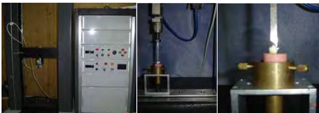
Figura 12: (a) Máquina de ensaios de cisalhamento, (b) corpo de prova, (c) adaptação do cinzel ao bráquete.
