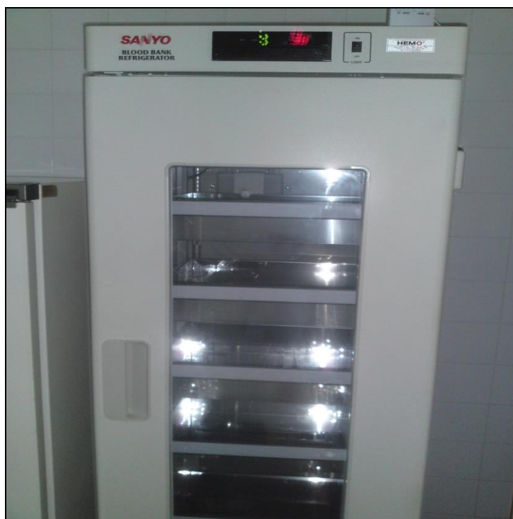
FIGURA 1. Refrigerador vertical para banco de sangue. (Fonte: SACCO, 2012).
