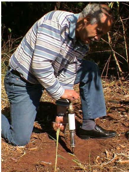
Figura 9. Avaliação da resistência do solo ao cisalhamento com aparelho sheargraph .
