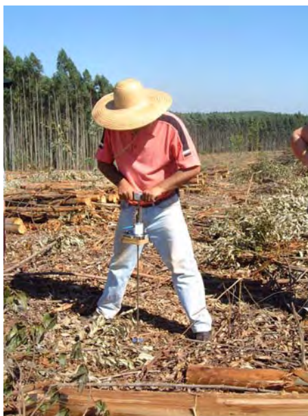
Figura 8. Determinação da resistência do solo à penetração com penetrógrafo Soil Control .
