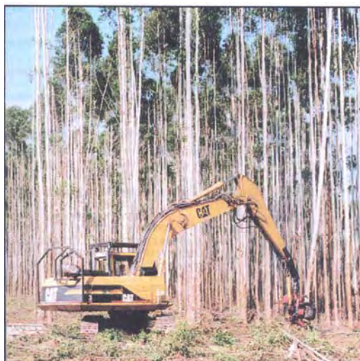
Figura 1. Harvester Caterpillar 320B em operação de corte florestal.
