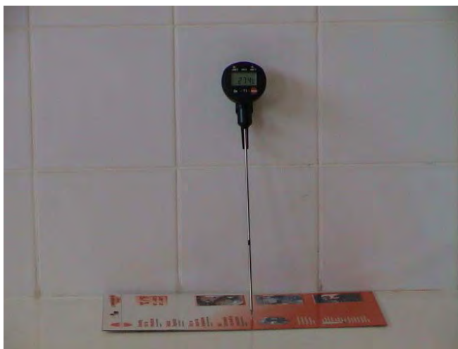
Figura 6. Geotermômetro Testo empregado na pesquisa.
