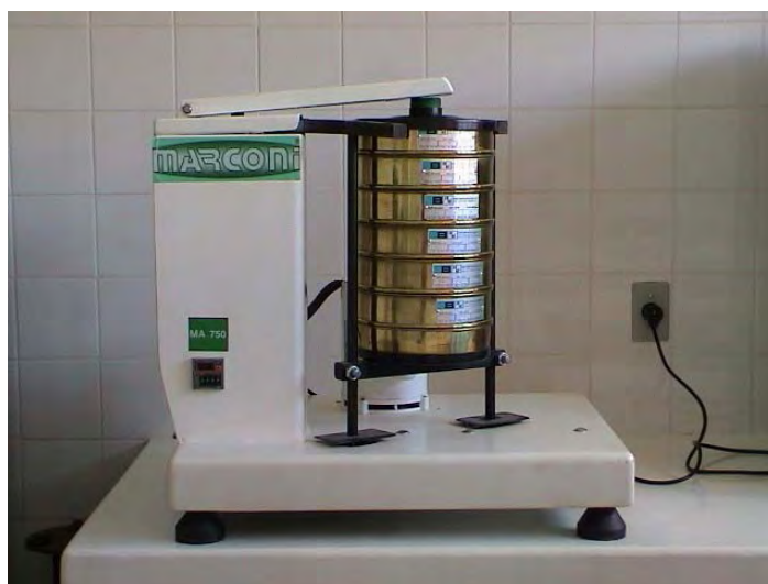
Figura 7. Aparelho vibratório para peneiramento a seco de amostras de solo.
