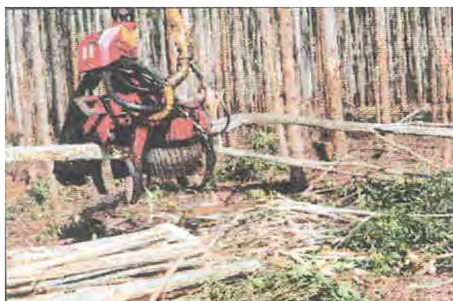
Figura 2. Cabeçote derrubador-processador em operação.
