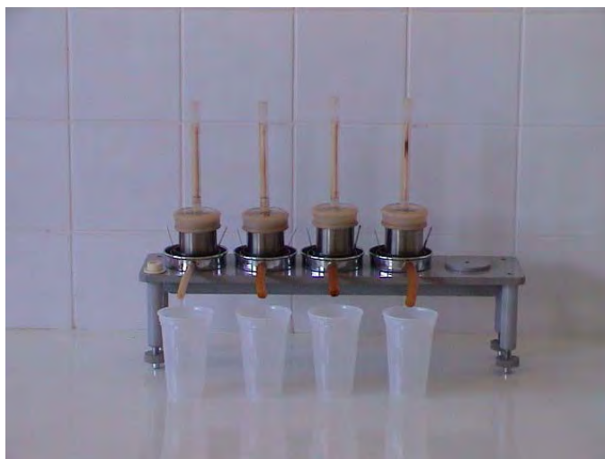
Figura 5. Permeametro de carga variável com amostra de solo saturada.
