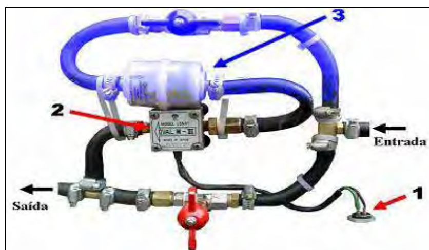
Figura 2. Fluxômetro instalado no trator para determinação do consumo de combustível (acoplamento ao sistema de aquisição de dados (1), fluxômetro (2) e filtro de combustível (3). (Fonte: Seki, A.S, 2007).
