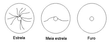
**Figura 64:** Aspecto do rompimento dos filmes de fécula de mandioca em função da concentração de glúten.
