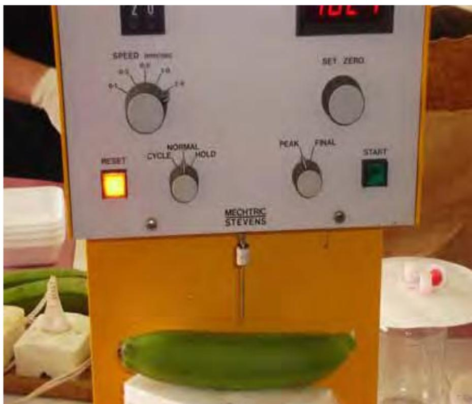
**Foto 5** - Texturômetro utilizado no experimento.
