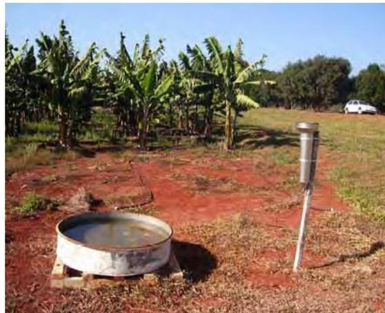
**Foto 3-** Tanque Classe A utilizado no experimento.
