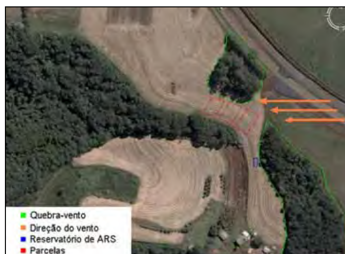
Figura 14: Influência do vento na uniformidade de distribuição.
