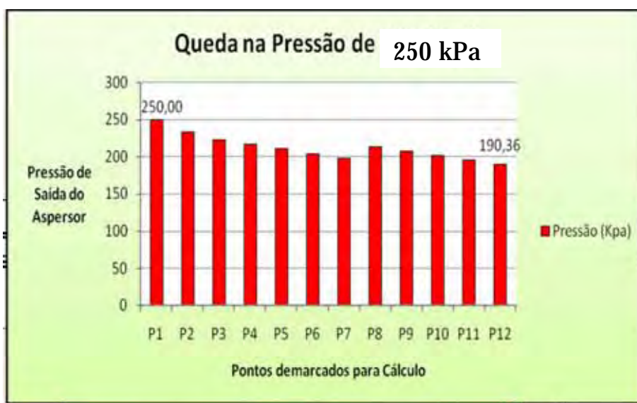
Figura 18: Redução da pressão ao longo das linhas principais e laterais para 250 kPa.
