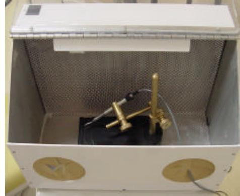
Figura 2- Caixa com sistema de aspiração de pó para preparo do grupo de dentes do sistema de abrasão a ar
