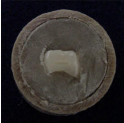
Figura 1: Corpo de prova incluído em bloco de resina acrílica com a canaleta preparada
