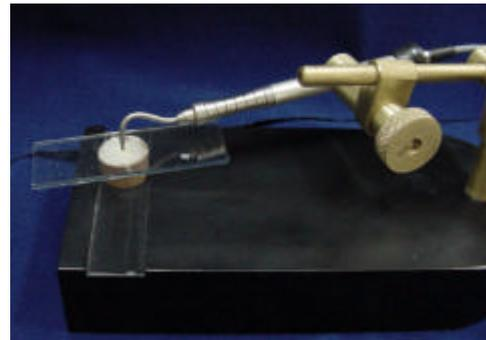
Figura 4 – Sistema de abrasão a ar em posição para desgaste do dente (observar lâmina de vidro que determina a distância do aparelho ao dente em 2 mm).
