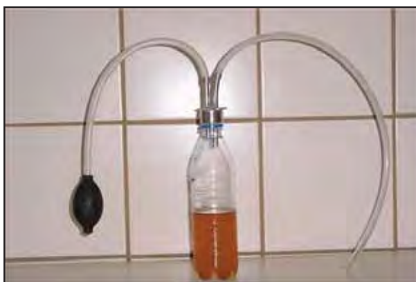
Figura 1. Glossador (extrator) manual portátil de Natmel desenvolvido pelo Projeto Abelhas Nativas (PAN).
