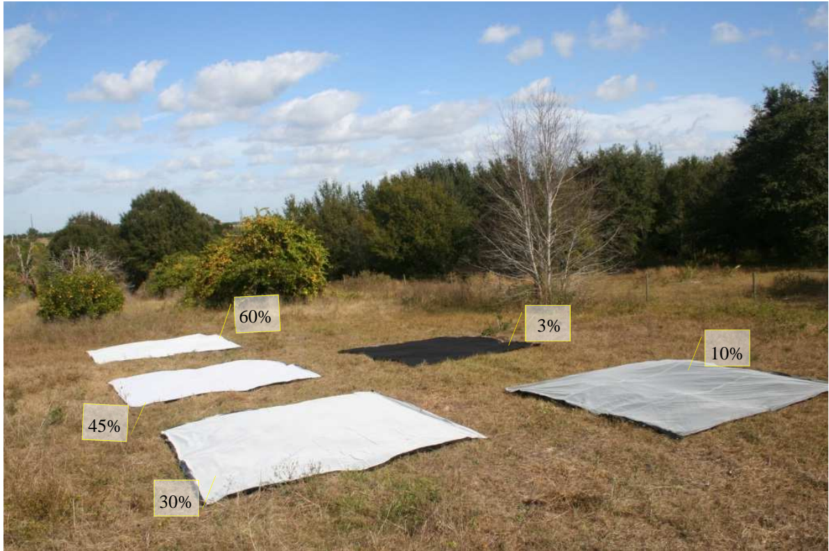
Figura 12. Lonas de calibração de diferentes níveis de cinza instaladas no pomar.
