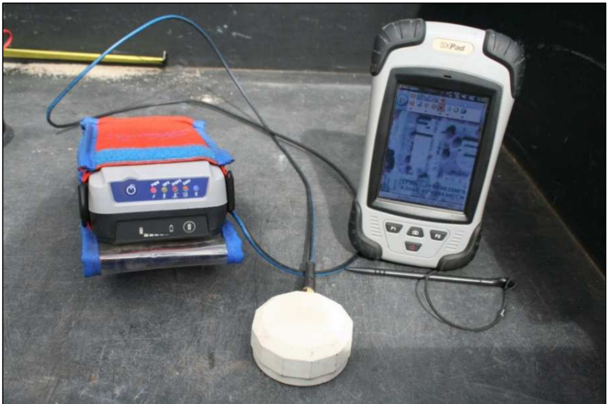
Figura 9. Equipamento GPS SX Blue II-B utilizado no georreferenciamento das amostras.
