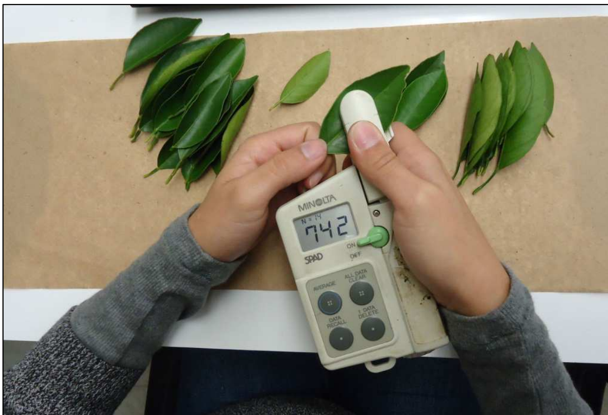
Figura 11. Leituras dos valores SPAD correspondentes às medidas indiretas do teor de clorofila na folha.
