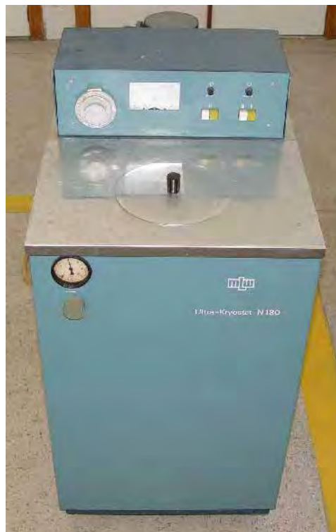
Figura 3. 13 – Dispositivo de controle de temperatura com câmara de nitrogênio líquido.
