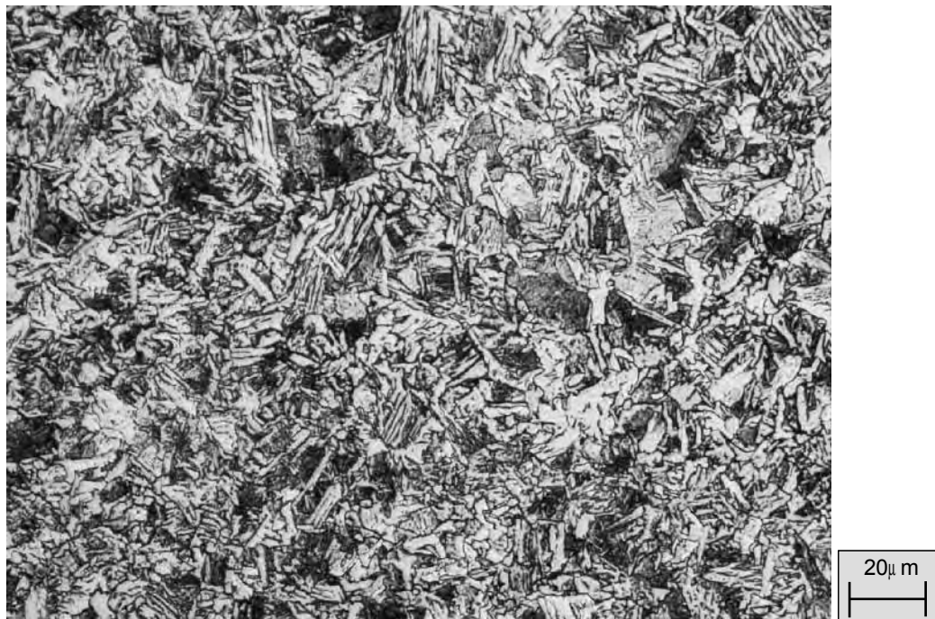
Figura 4.6 – Microestrutura do aço ASTM A516 austenitizado a 870 °C e resfriado em óleo a 23 °C/s. Ataque nital 2%.
