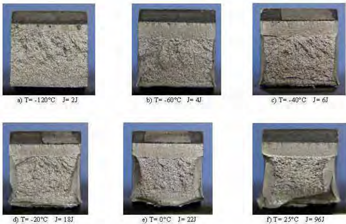
Figura 4.41 - Fractografia da superfície de fratura do aço A516 R 23 °C/s, corpo-de-prova pré-trincado.
