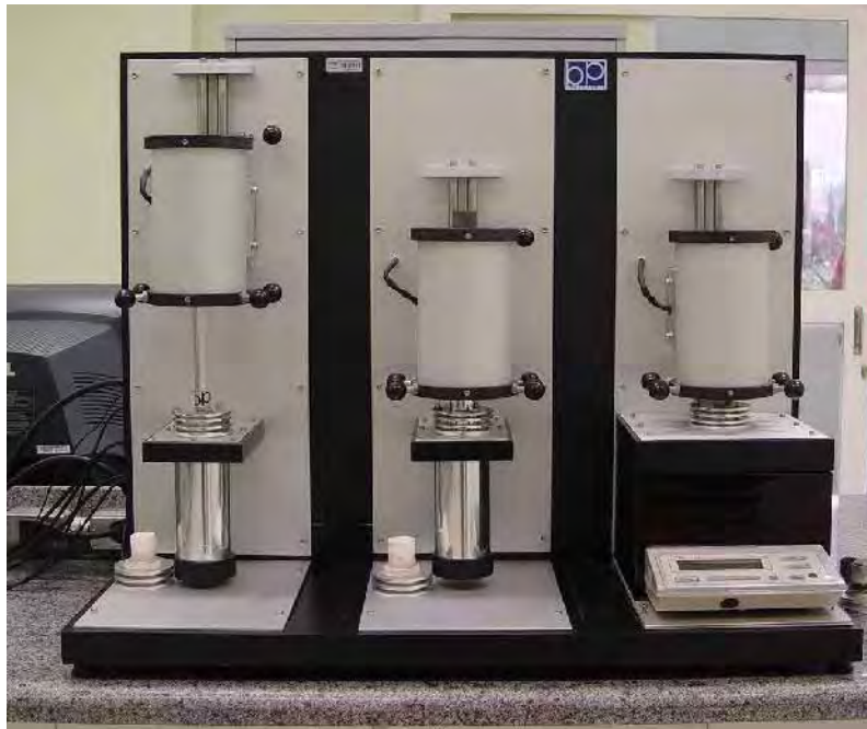
Figura 3.1 – Sistema de análise térmica utilizado nos ensaios de dilatometria.
