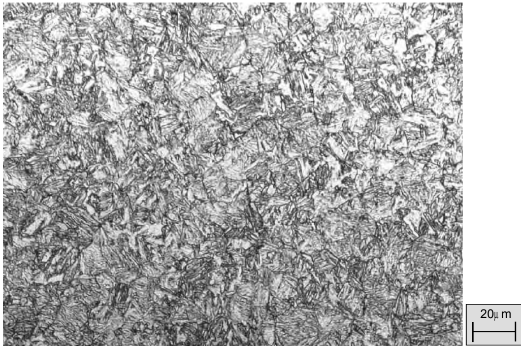
Figura 4.10 – Microestrutura do aço ASTM A 516 austenitizado a 870 °C por 40 minutos resfriado a 50 °C/s seguido de revenido a 350 °C por 60 minutos
