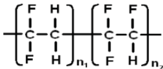
Figura 3.2 – Fórmula estrutural plana do P(VDF-TrFE) 70/30. Os índices n_1 e n_2 dão a relação em massa do PVDF e TrFE, respectivamente
