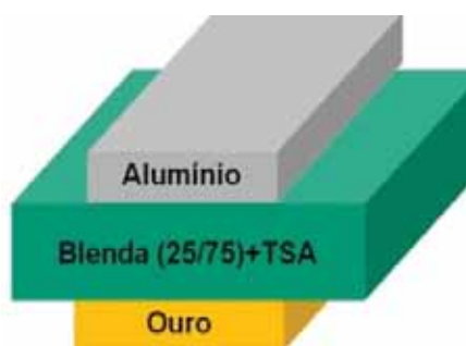
Figura 4.3 – Esquema do dispositivo após a formação do filme e posterior deposição dos eletrodos.
