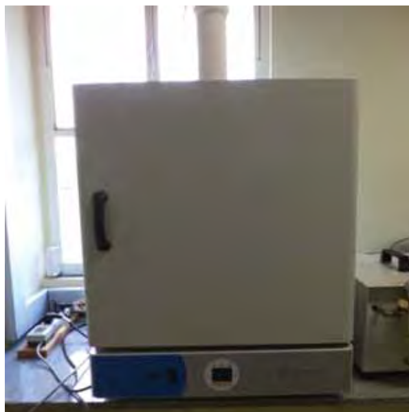
Figura 4.1 - Estufa com exaustão, marca Fanem modelo 315SE.
