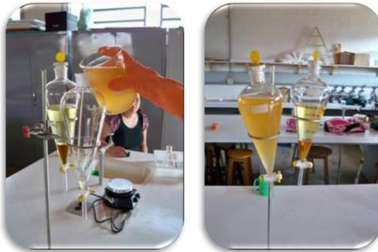
Figura 2. Síntese do biodiesel e separação das fases, glicerina e biodiesel.
