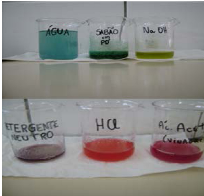
Figura 5. Fotos indicando os mesmos reagentes da foto anterior, agora com o indicador. Pode-se perceber uma intensa mudança de coloração. A água de torneira, sabão em pó e hidróxido de sódio (NaOH), de cores azul, verde e amarela são básicos. O detergente, que adquire a coloração do suco de repolho roxo, é neutro e o ácido clorídrico (HCl) e o vinagre (ácido acético), apresentando coloração avermelhada, são ácidos.
