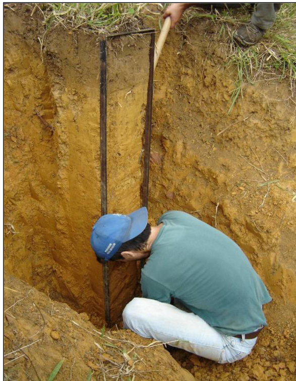
Figura 2 - Retirada de um macropedolito de Cambissolo durante trabalho de campo realizado na cidade de Iporanga - SP, 2010.
