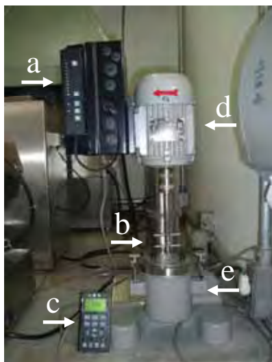
Figura 1.6. Imagens do moinho atritor . a) comando; b) haste tipo molinex, c) controle, d) motor e e) câmara.
