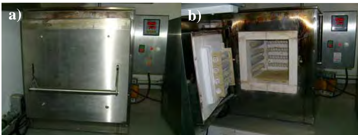
Figura 3.1. Forno utilizado para a calcinação do precursor da fase cerâmica KSN. a) Forno fechado e b) Forno aberto.
