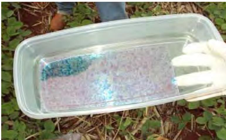
Figura 14. Lâmina de vidro acondicionada em recipiente plástico após aplicação do corante FDC-1.
