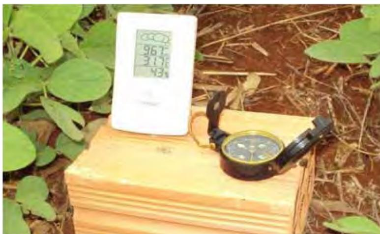
Figura 8. Baro-termo-higrômetro e bússola, utilizados para determinar as condições climáticas de cada tratamento.
