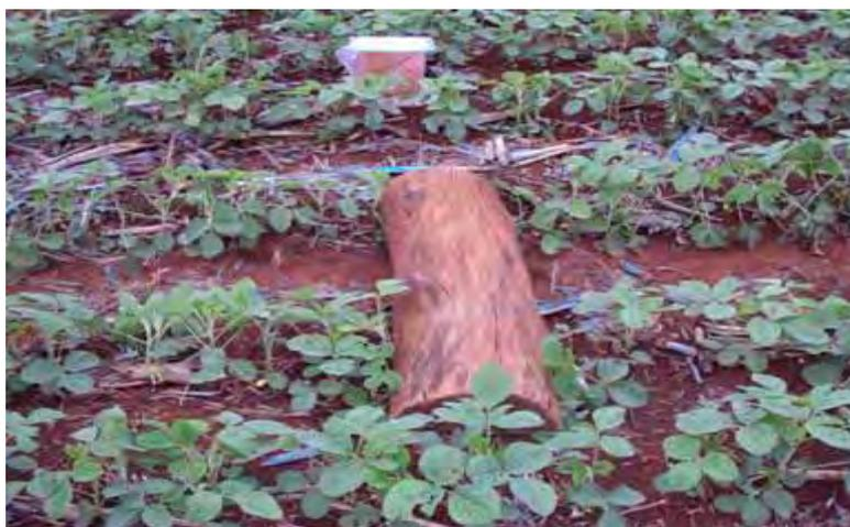
Figura 7. Obstáculo de madeira posicionado no percurso do conjunto trator/pulverizador.
