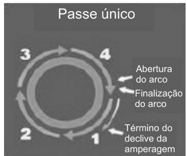
Figura 1 - Seqüência de soldagem indicando os quatro quadrantes da soldagem do tubo.
