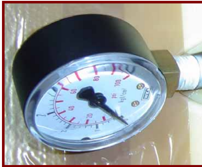
Figura 6 - Manômetro, marca WIKA, de 0 a 7 kgf/cm 2 com subdivisões 0,25-0,25 e 0 a 100 PSI com subdivisões 50-50.
