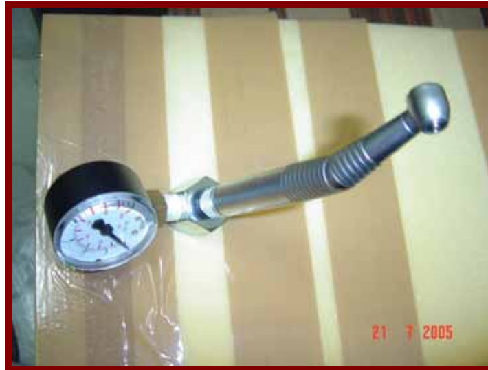
Figura 10 – Instrumento de alta rotação fixada em uma espuma rígida a fim de evitar possíveis vibrações e interferências.
