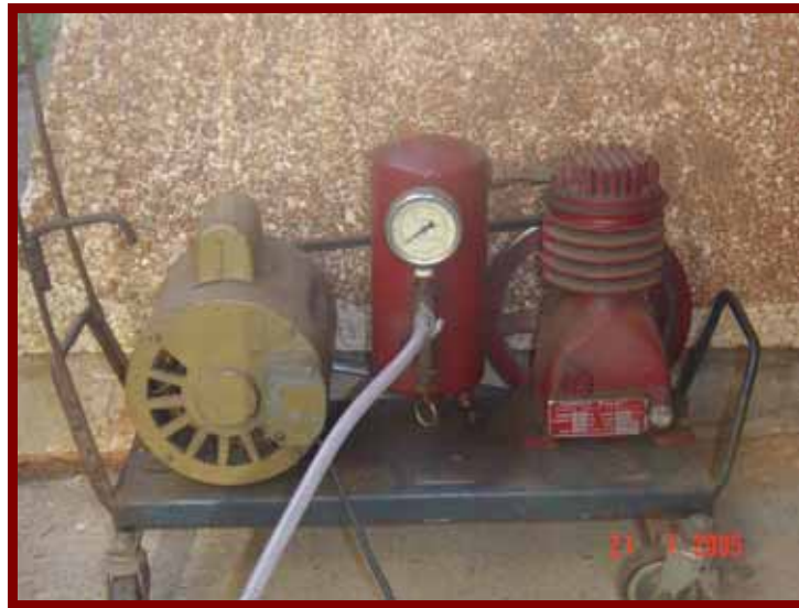
Figura 5 - Suprimento de ar sob compressão por bico de ar-comprimido, marca Douat, modelo CD70D, com pressão de ar de 60 a 80 PS.
