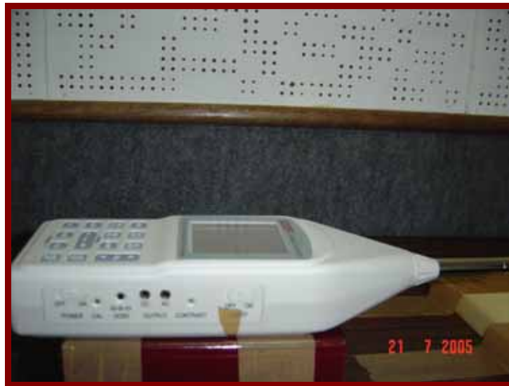
Figura 7 - Decibelímetro com filtro de banda de oitava e terça oitava, modelo DEC-5030, da INSTRUTHERM, digital.
