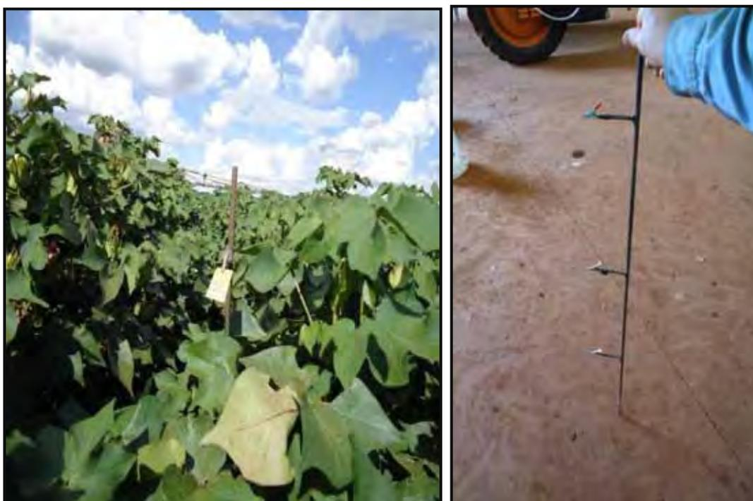
**Figura 8.** Haste de ferro para fixação dos papéis hidrossensíveis na avaliação da cobertura da pulverização (Experimento II).
