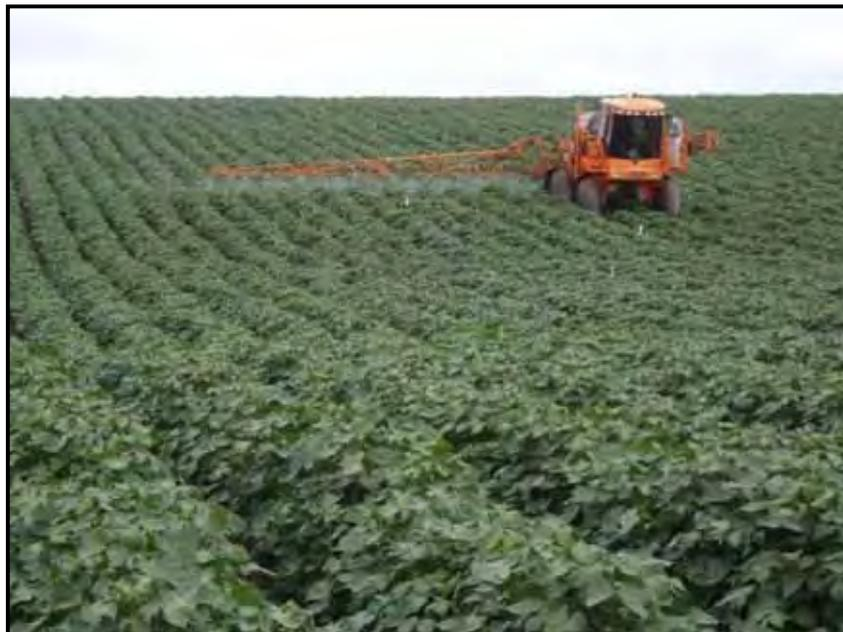
**Figura 2.** Pulverização na área experimental utilizando um dos lados da barra do pulverizador autopropeleido, seguindo o rastro de caminhamento do equipamento no carreador entre os blocos.
