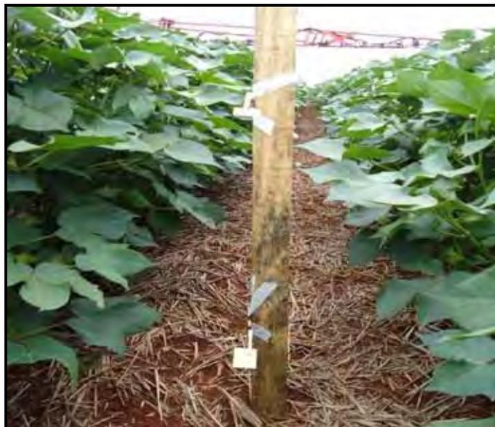
**Figura 6.** Papel hidrossensível utilizado para a avaliação da cobertura da pulverização (Experimento I).
