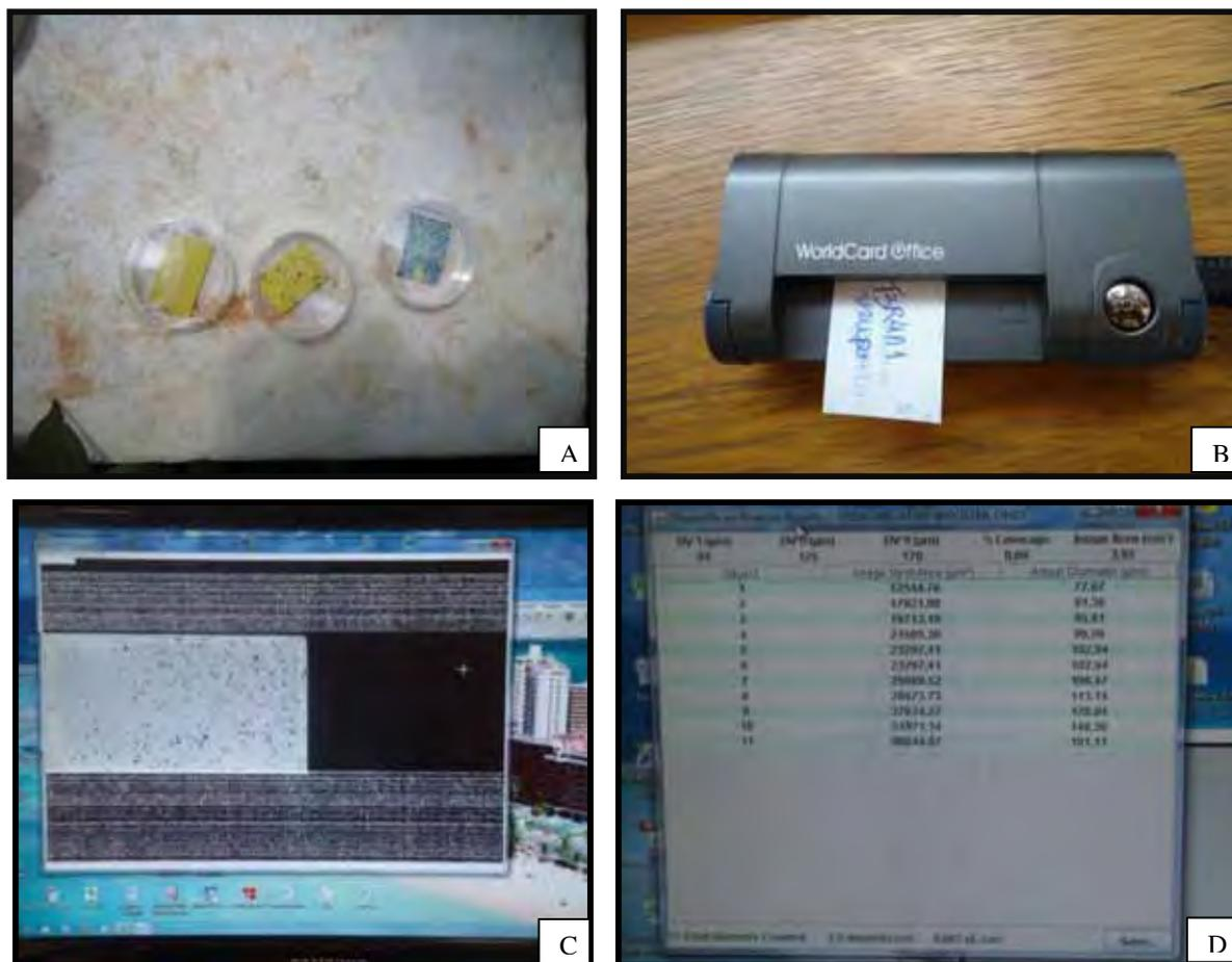
**Figura 9.** Etapas na avaliação da cobertura e espectro das gotas da pulverização: coleta e armazenamento dos alvos artificiais a campo (A); digitalização da imagem (B); seleção da área analisada (C) e resultados fornecidos pelo programa Deposit Scan (D).
