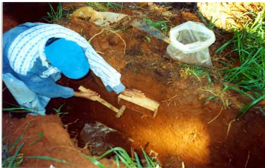
Figura 9: Amostragem do solo pela remoção de monólitos para quantificação de raízes finas em diferentes profundidades do solo.
