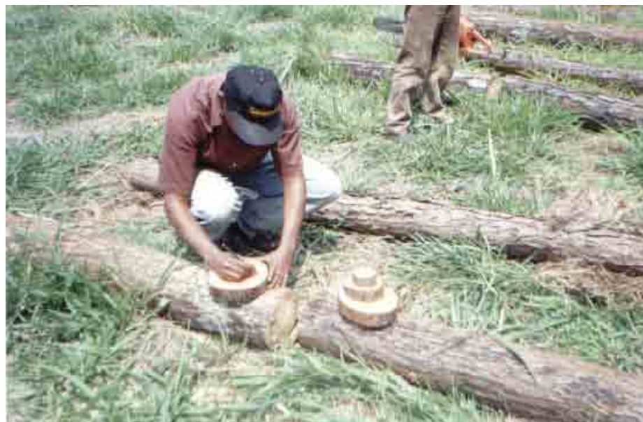
Figura 5: Amostragem de discos de madeira ao longo do tronco de pinheiros para determinação de sua biomassa.
