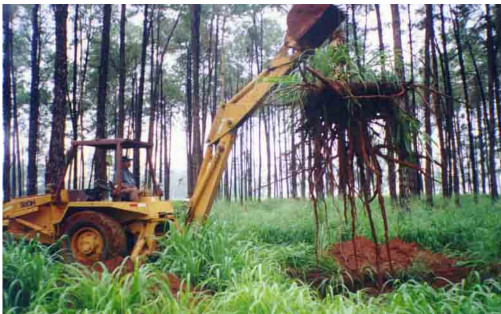
Figura 8: Remoção do sistema radicular de pinheiros por meio de alavancagem com retro-escavadeira.
