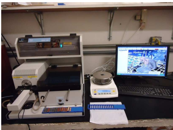
Figura 8 – Espectrômetro de Absorção Atômica - SMS 100 da Perkin Elmer
