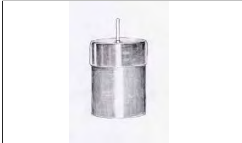
FIGURA 11 – Pino de fibra de vidro posicionado através da matriz metálica.
