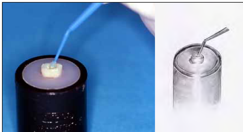
FIGURA 15 – Aplicação do sistema adesivo (Single Bond/ 3M ESPE).
