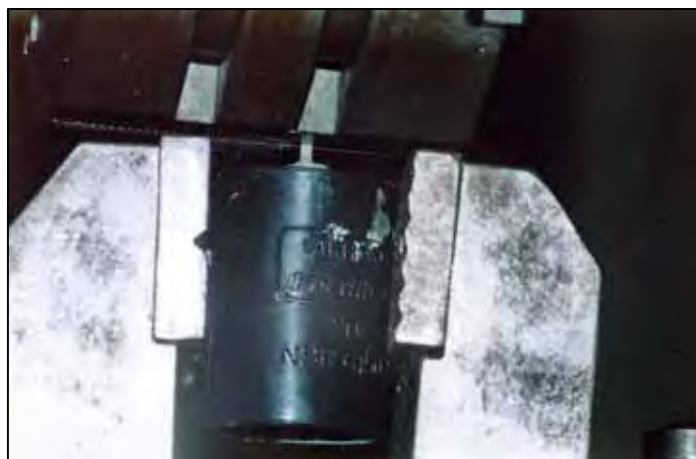
FIGURA 40 – Detalhe do pino preso ao mordente da máquina, para a realização do teste de tração mecânica.
