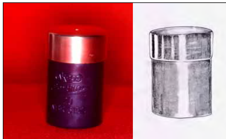
FIGURA 10 – Matriz metálica adaptada ao tubo de PVC.
