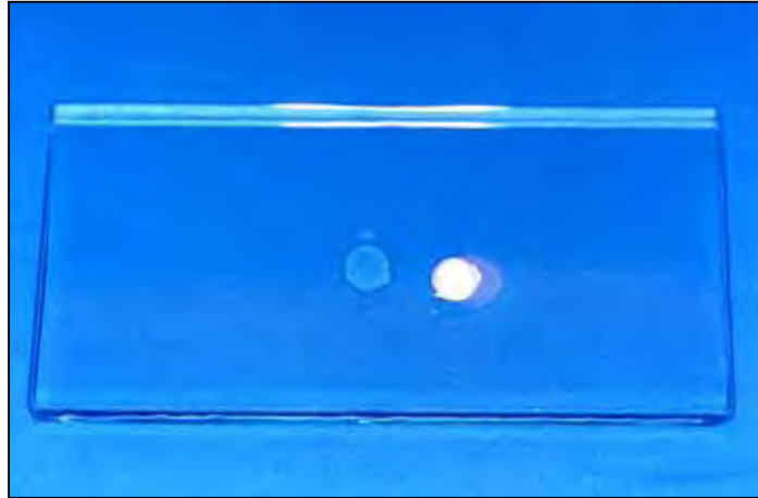
FIGURA 23 – Pó e líquido do cimento, proporcionados sobre placa de vidro.
