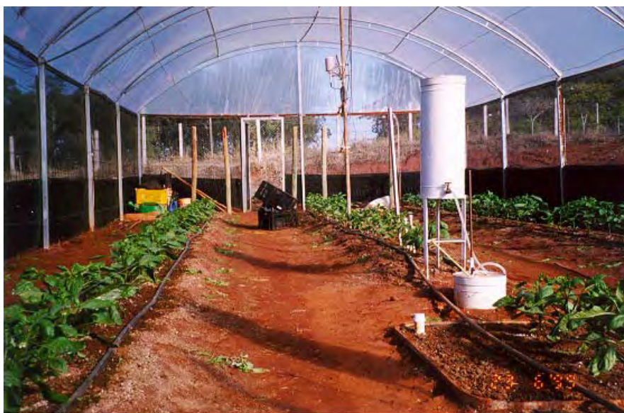
Figura 2. Vista interna do ambiente protegido e lisímetro (Foto: Cunha, A.R.).
