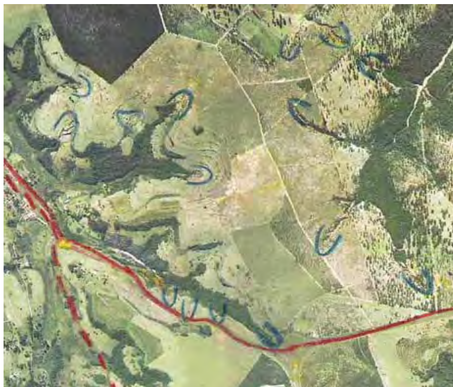
Figura 4.6 – Exemplo de interpretação das feições de erosão (em azul) nas fotografias aéreas de 2006
