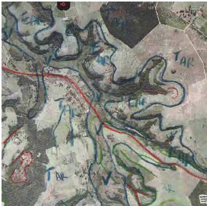
Figura 4.5 – Exemplo de interpretação das unidades homogêneas e feições de erosão nas fotografias aéreas de 2006
