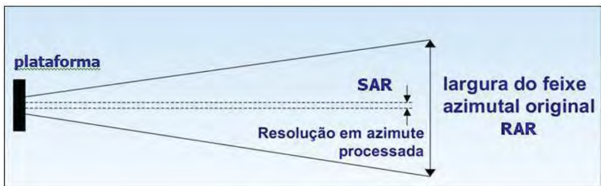
Figura 13 - Diferença entre resolução em azimute SAR e RAR.
