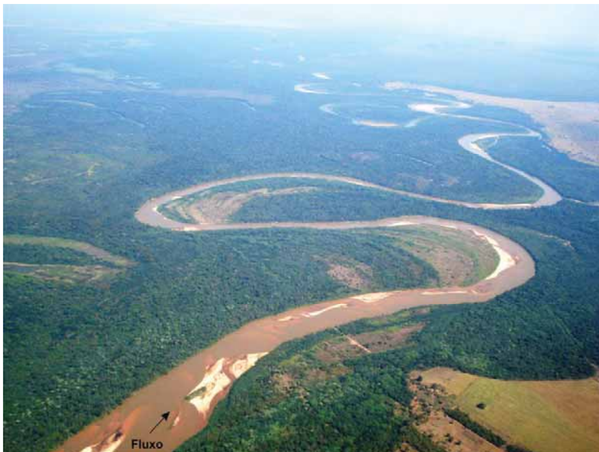
Figura 20 – Início do canal meandrante do rio Vermelho no segmento II. As barras central e de pontal apontam alta concentração de transporte de sedimentos. Localização: 16°29'20" S e 54°50'45" O.
