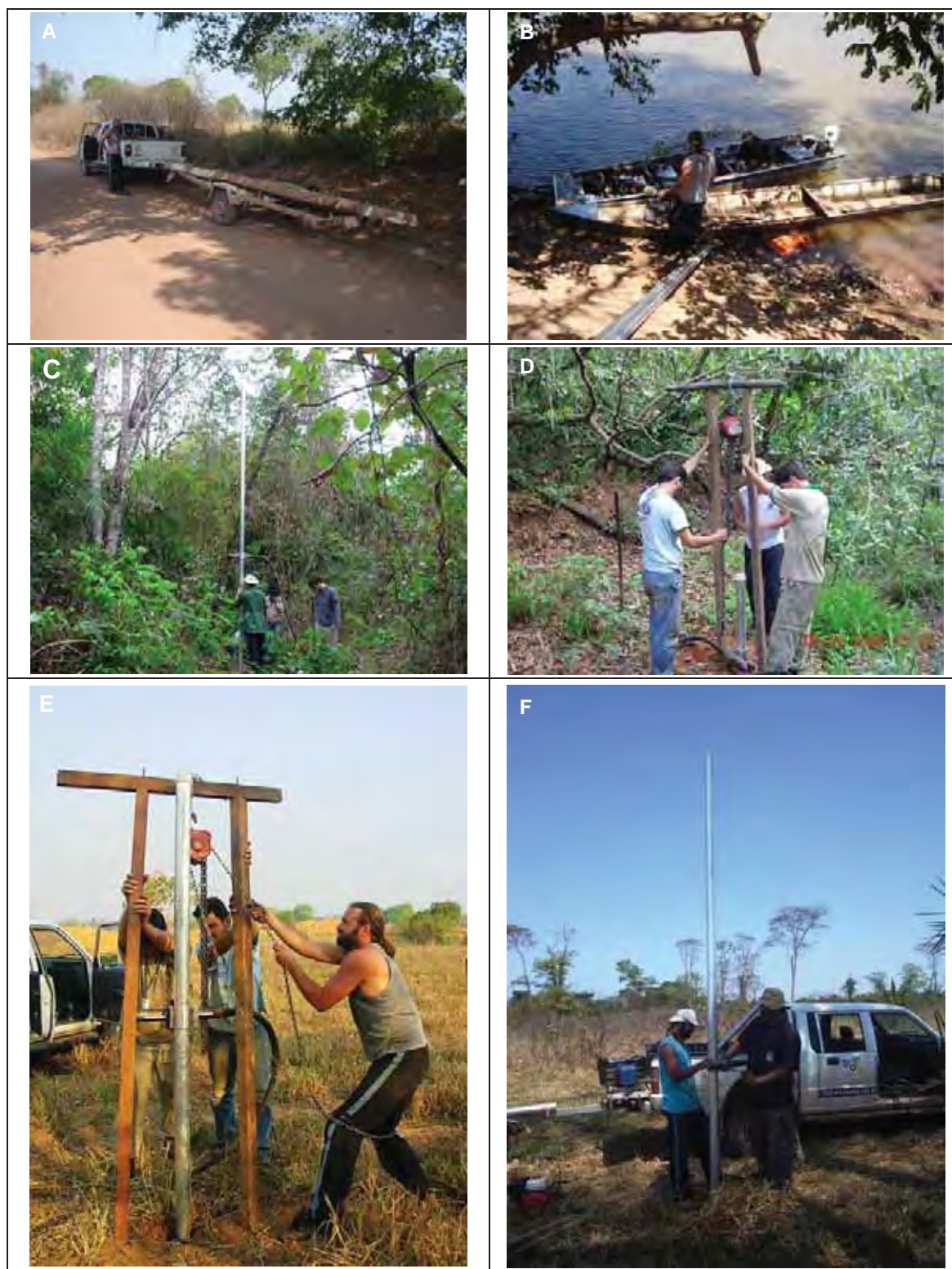
Figura 57 – Campanha de campo para amostragem de sedimentos por sondagens de vibrotestemunhador no megaleque do rio São Lourenço: A) reboque para transporte dos tubos de alumínio com 6 m de comprimento; B) uso de barco para pontos de difícil acesso por estradas vicinais. Sondagens na planície confinada: C) ponto SL009; D) ponto SL011. Sondagens no terraço: E) ponto SL007 e F) ponto SL014.
