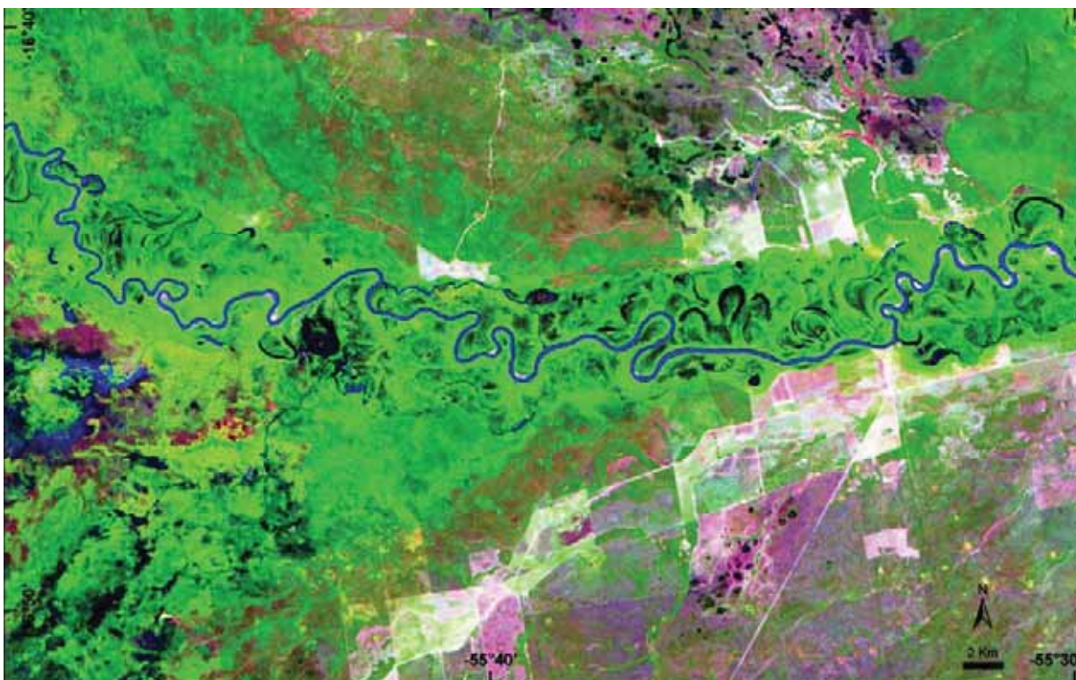
Figura 22 – Abandono do confinamento da planície fluvial no segmento IV. Observa-se a dinâmica de corte de meandros os quais reativam durante as cheias e funcionam como zona de amortecimento de inundação (Imagem Landsat 7 R4G5B3 2001).
