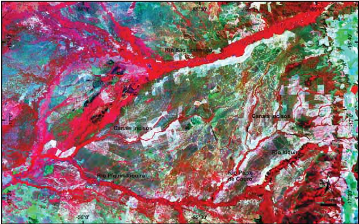
Figura 11 – Confluências de tributários na planície aluvial dissecada. Controlado pelo nível de base do rio Piquiri, os canais incisos situados nos lobos abandonados a sul estão erodindo a superfície obliterando paleocanais distributários (Imagem Geocover Landsat 7 Cercas 2000, 4R7G2B).
