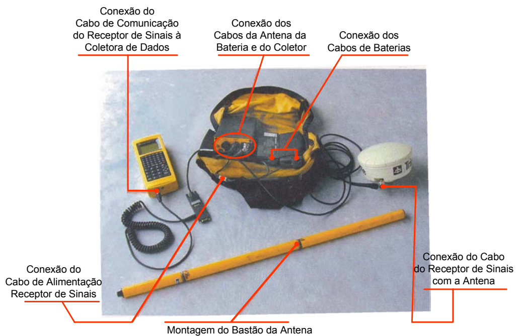
Foto 5 – Detalhe das conexões a serem realizadas antes da utilização do DGPS.
