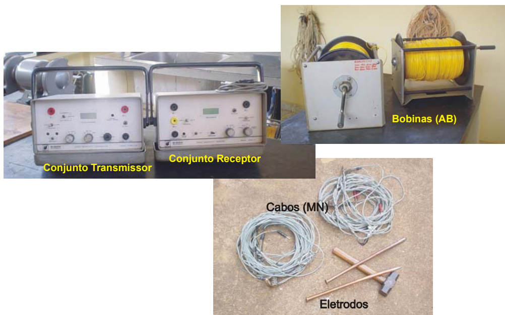
Foto 1 – Conjuntos transmissor e receptor (aparelho da marca Bison ), bobinas, cabos e eletrodos utilizados na realização dos ensaios geofísicos.
