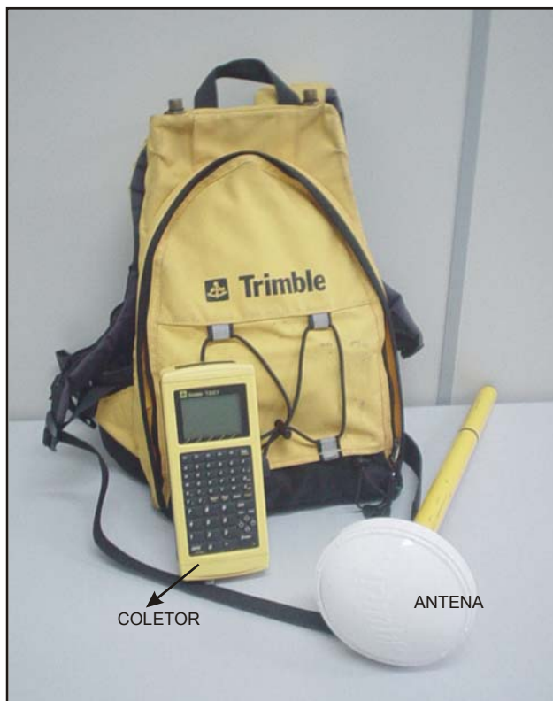
Foto 4 – Detalhe do DGPS, com antena e receptor.
