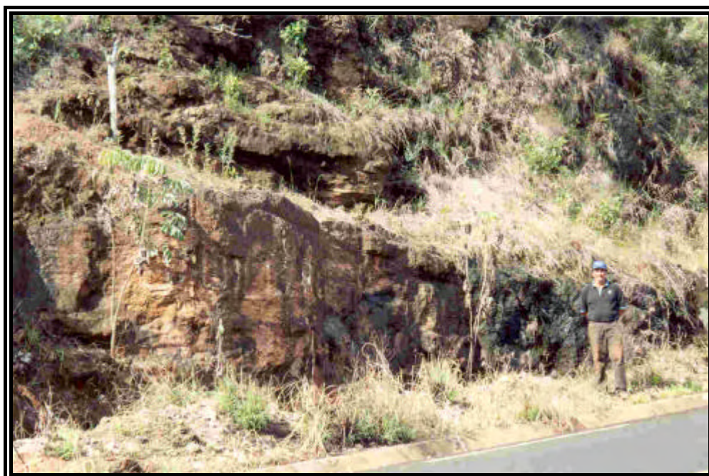
Foto 4.4 – Afloramento expondo lentes de arenito médio a grosso, maciço, cimentado por \text{CaCO}_3 . TM – 100 - Entrada de Comendador Gomes (MG).
