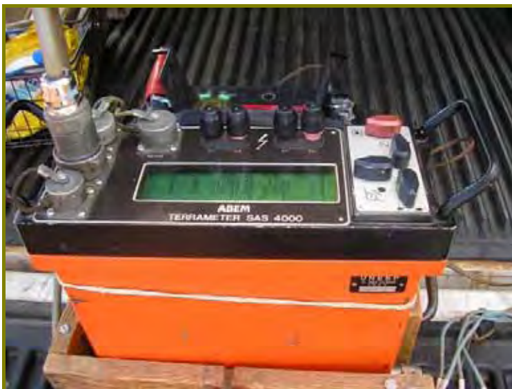
Figura 4.9: Foto do resistímetro Terrameter SAS 4000 em operação.
