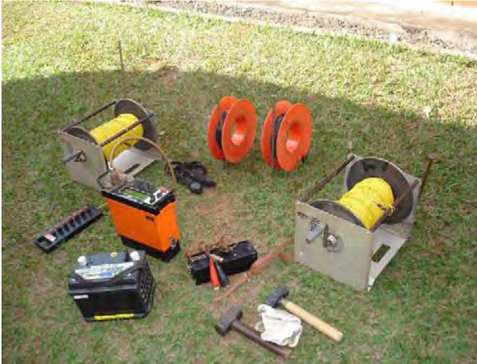
Figura 4.8: Equipamentos utilizados nos ensaios geofísicos em Ji-Paraná, RO.
