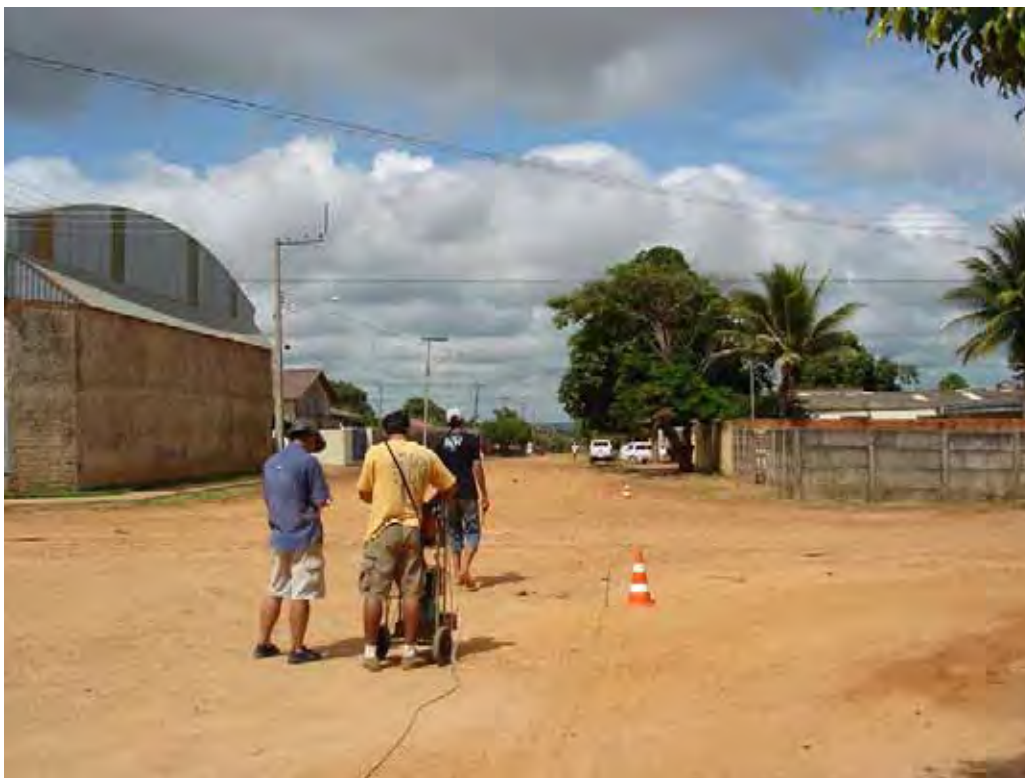
Figura 5.33: Foto ilustrativa do ensaio de caminhamento elétrico na Rua São Paulo.
