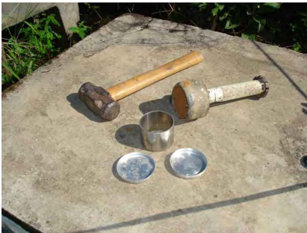
Figura 4.3: Material utilizado na coleta de amostras dos perfis de poços na área estudada.
