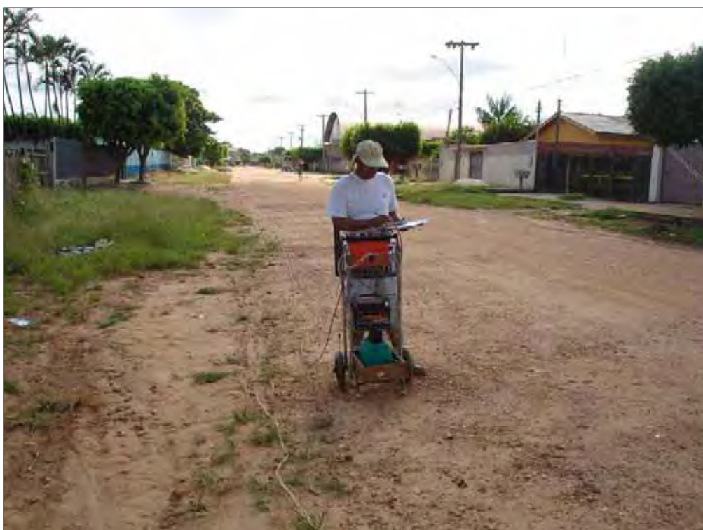
Figura 5.32: Foto ilustrativa do ensaio de caminhamento elétrico na Rua São Luiz.
