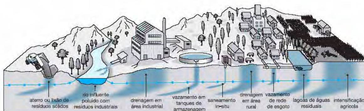
Figura 3.2: Processos comuns de poluição da água subterrânea (FOSTER, 2006).
