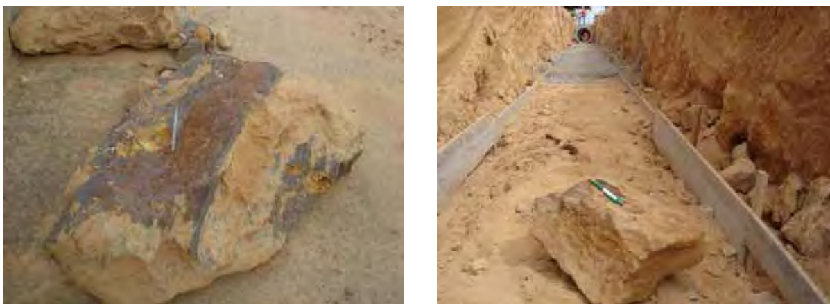
Figura 5.31: Foto de bloco de laterita localizado em escavação na Rua Manoel Franco esquina com Rua T-10.
