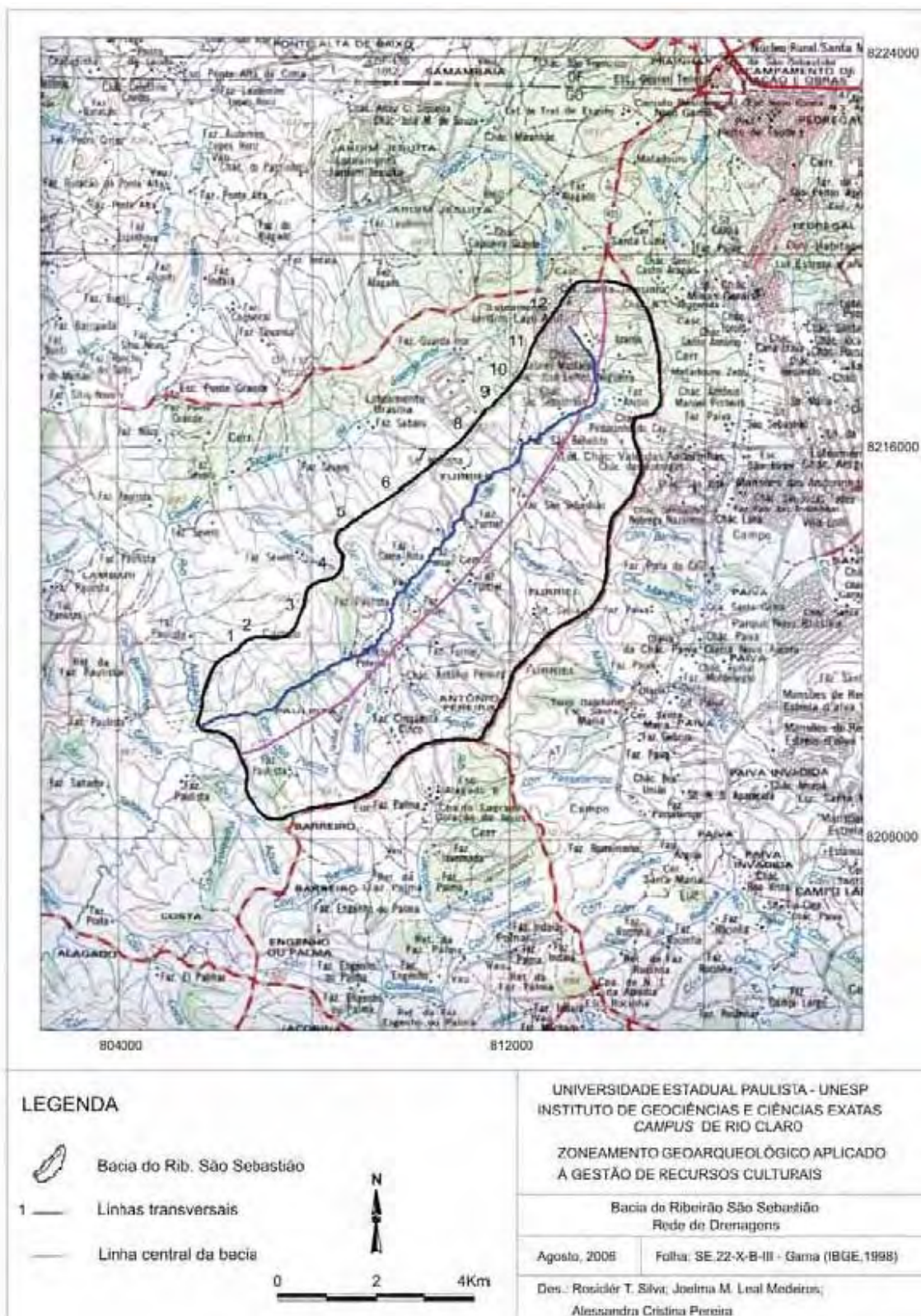
Figura 5.69 - Bacia do ribeirão São Sebastião, com indicação dos perfis realizados para o fator de simetria topográfica transversal
