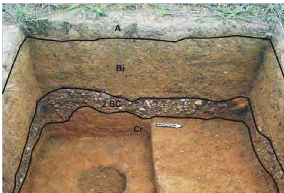
Figura 5.34 - Perfil pedológico da sondagem N0N, evidenciando os horizontes A; Bi; 2BC e Cr. Cambissolo Háplico Tb Distrófico típico
