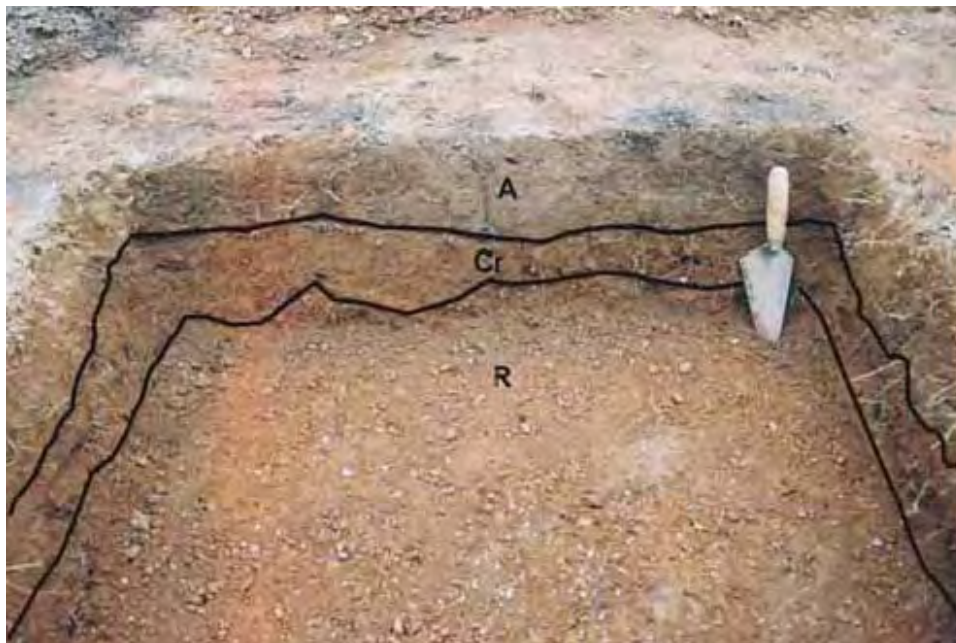
Figura 5.62 - Perfil pedológico da sondagem NE10J, evidenciando os horizontes A; Cr e R. Neossolo Litólico Distrófico típico
