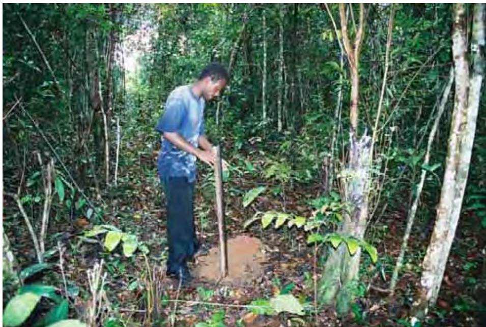
Figura 4.6 - Abertura de sondagem com boca-de-lobo (cavadeira)
