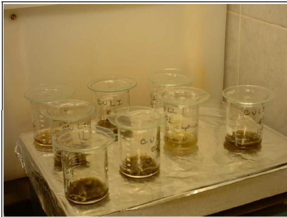
FIGURA 20 – Béqueres com as amostras de sedimentos na chapa.
