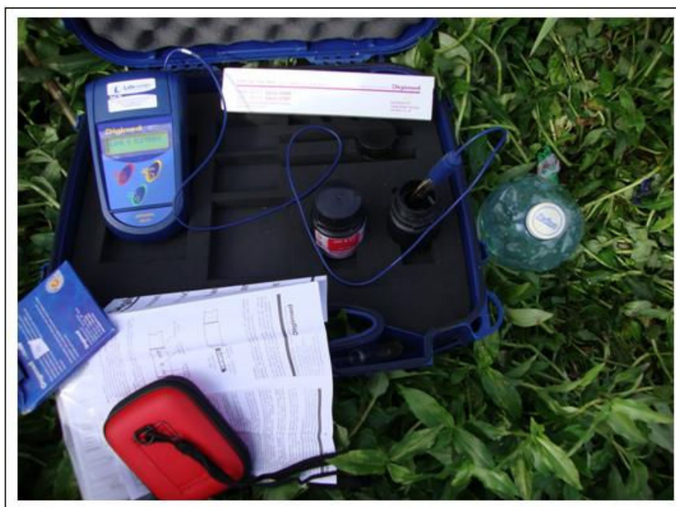
FIGURA 15 – Medição “ in situ ” do pH e da temperatura nas amostras de água utilizando DIGIMED DM-2.
