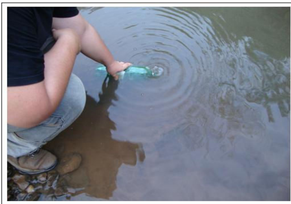
FIGURA 14 – Coleta de amostra de água para análises químicas dos pontos RX1, RX3, RX5 e RX6 no Ribeirão dos Bagres, região de Franca (SP).
