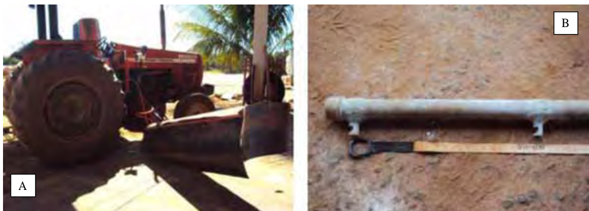
FIGURA 15. Conjunto trator + barra de herbicida (A). Detalhe do tubo de PVC \frac{3}{4} ” que foi acoplado a barra para aplicação da calda de cal (B).
