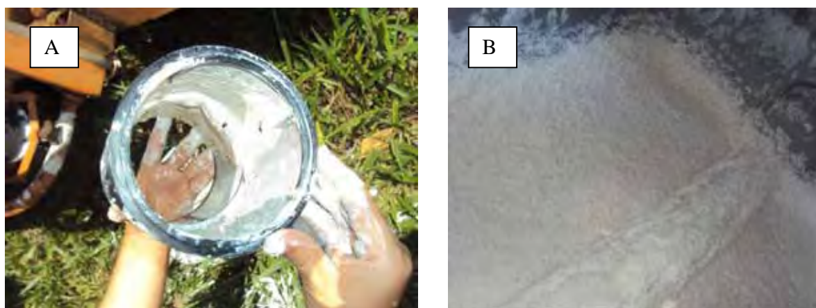
FIGURA 17. Deposição de cal hidratada no filtro do reservatório da barra de herbicida (A). Decantação de cal hidratada após a aplicação do tratamento (4) dentro do tanque de herbicida (B).
