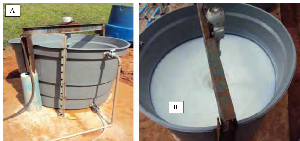
FIGURA 5. Conjunto caixa d'água + agitador (A). Agitação da cal que fica em suspensão (B).
