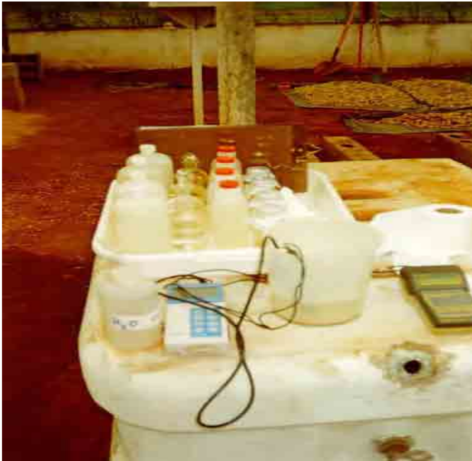
Figura 9. Amostras de águas coletadas para análise em laboratório após tratamento em “CWs”.
