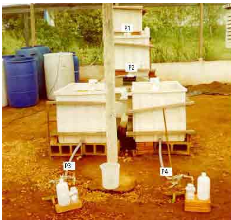
Figura 8. Ilustração do aspecto geral do protótipo do sistema construído de “wetlands”, com os pontos de coletas das amostras de água. Legenda: P1 = saída da caixa 1; P2 = saída da caixa 2 (canal de aguapé); P3 = saída da caixa 3 (solo filtrante com Pistia stratiotes ) e P4 = saída da caixa 4 (solo filtrante).
