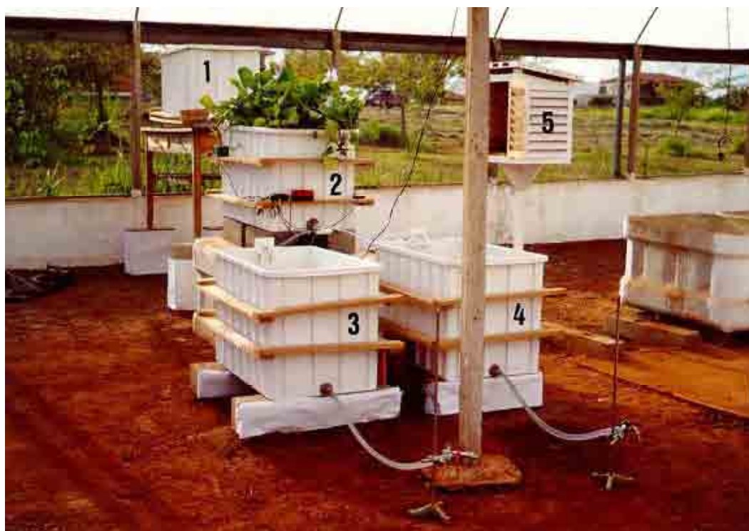
Figura 4. Montagem do sistema “constructed wetland” em escala piloto onde foram executados os ensaios. Legenda: caixas contendo: Caixa 1 efluente poluído (água no Rio Corumbataí); Caixa 2 macrófitas aquáticas (aguapé); Caixa 3 particulados (pedregulhos 3 tamanhos diferentes, solo e carvão de babaçu) e as macrófitas aquáticas Pistia stratiotes ; Caixa 4 particulados (pedregulhos 3 tamanhos diferentes, solo e carvão de babaçu) sem macrófitas. No abrigo 5 termômetro de mercúrio em vidro, para medir a temperatura ambiente, Borges (2001).
