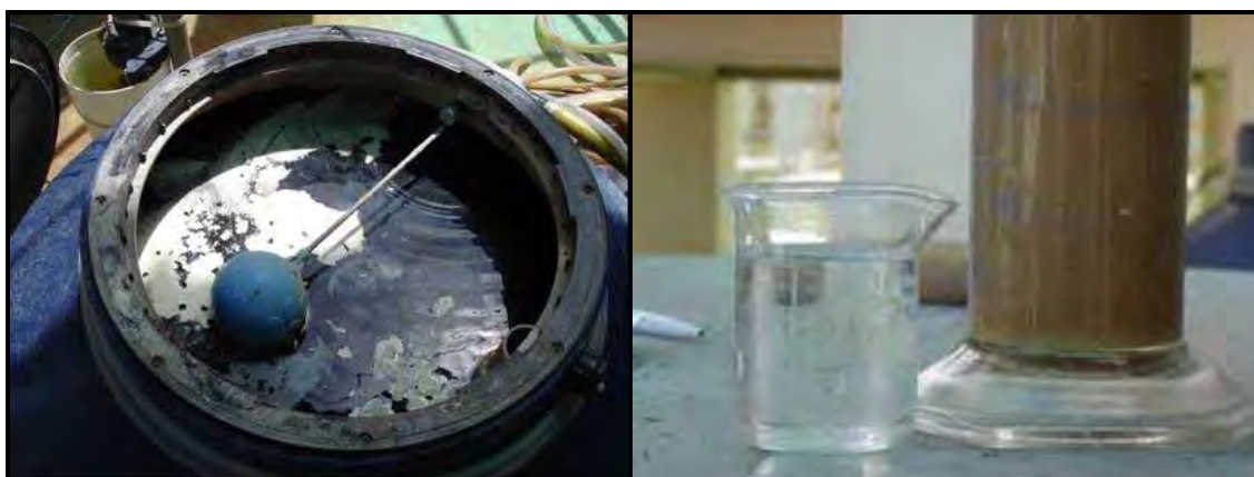
Figura 8. Reservatório de água de produção, na entrada do reator biológico, e amostras do efluente após o tratamento biológico (becker) e lodo biológico (proveta).
