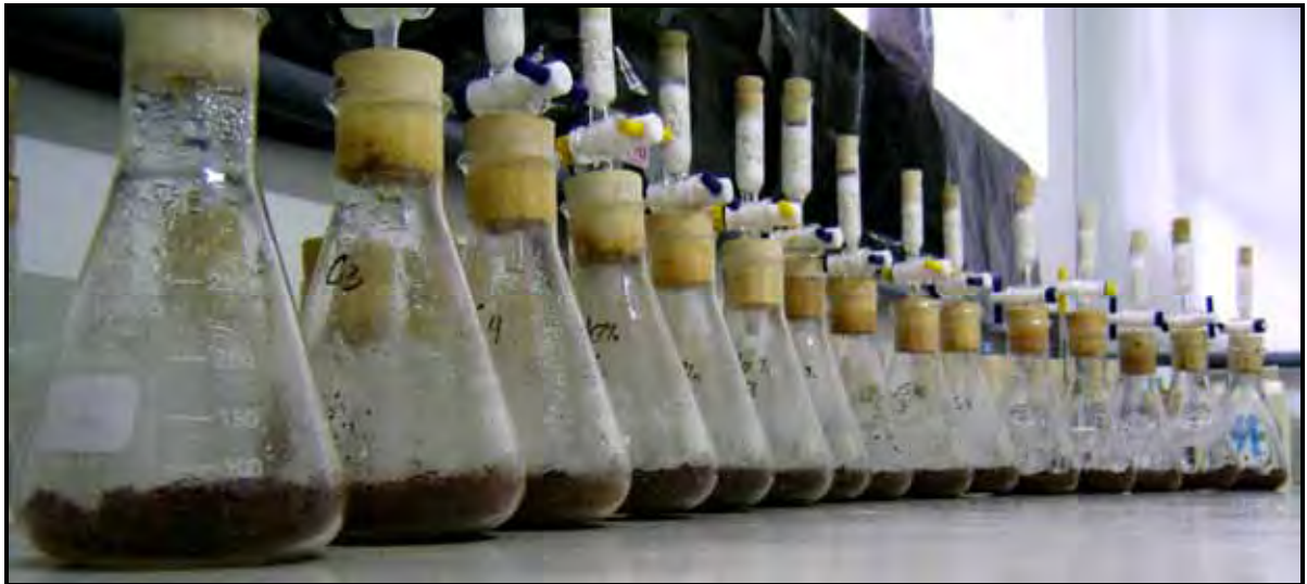
Figura 15. Respirômetros de Bartha e Pramer durante a realização do ensaio de biodegradação.
