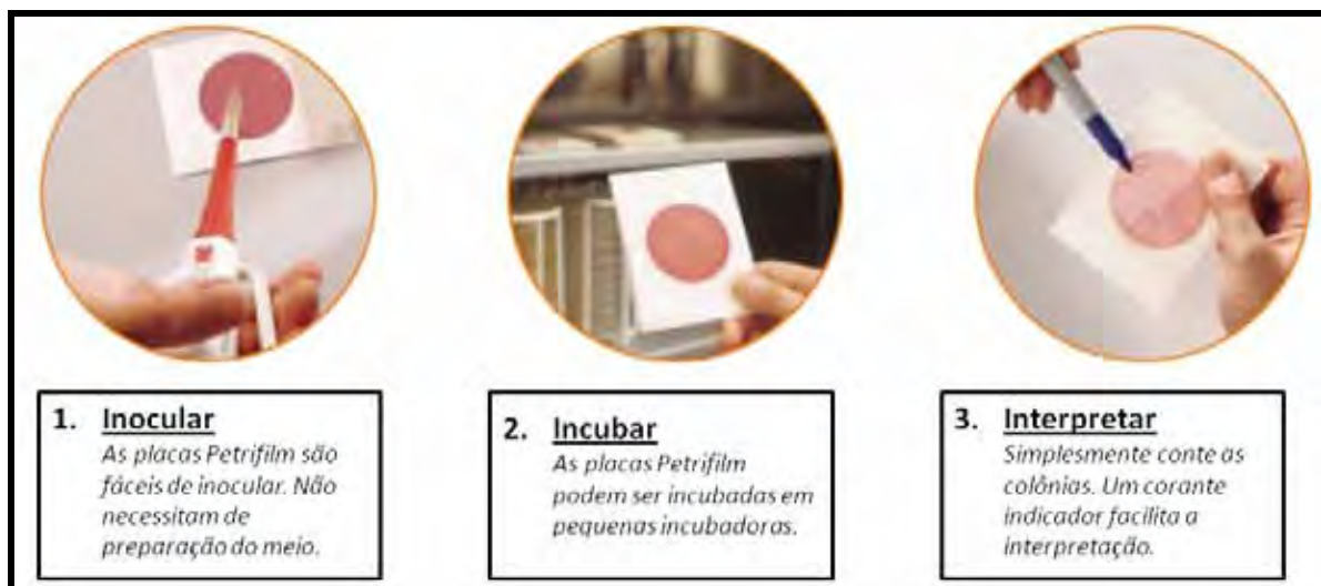
Figura 9. Esquema mostrando como utilizar as placas Petrifilm da 3M.
