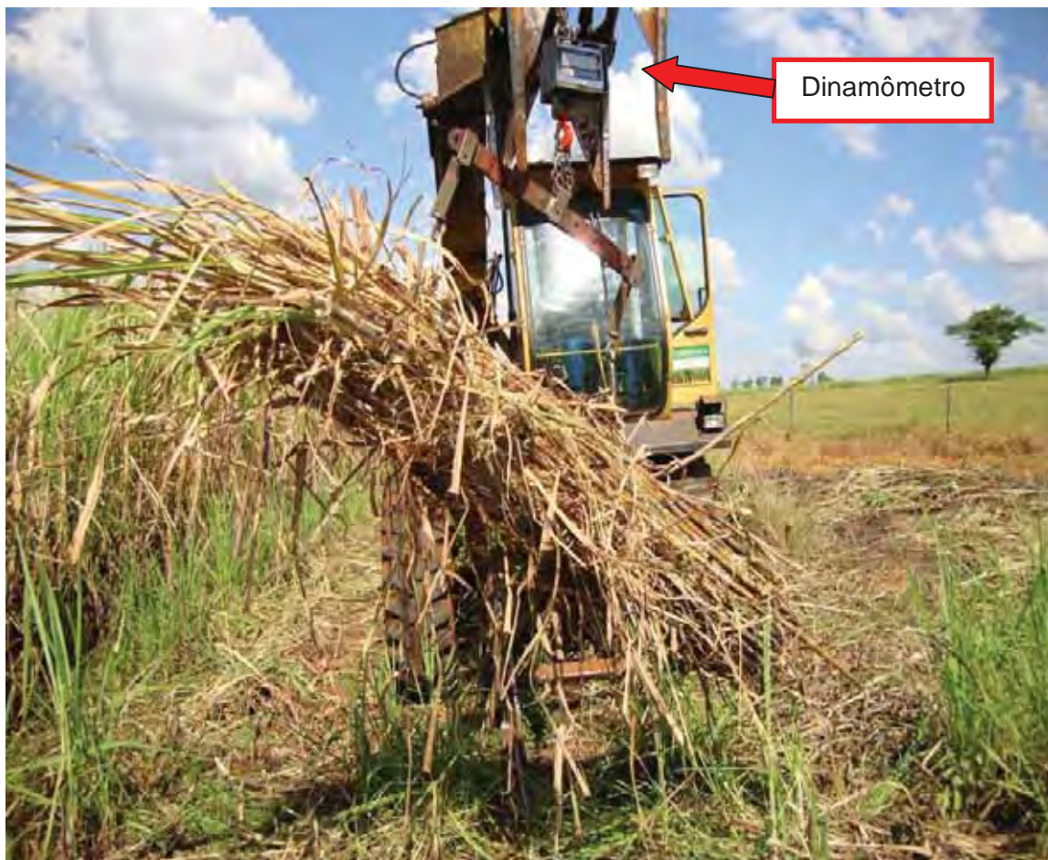
Figura 1. Feixe de cana-de-açúcar devidamente amarrado por duas cordas presas no suporte fixado ao dinamômetro com auxílio de ganchos. Dinamômetro acoplado ao suporte superior das garras de uma colhedora articulada por sistema hidráulico em um veículo automotriz.
