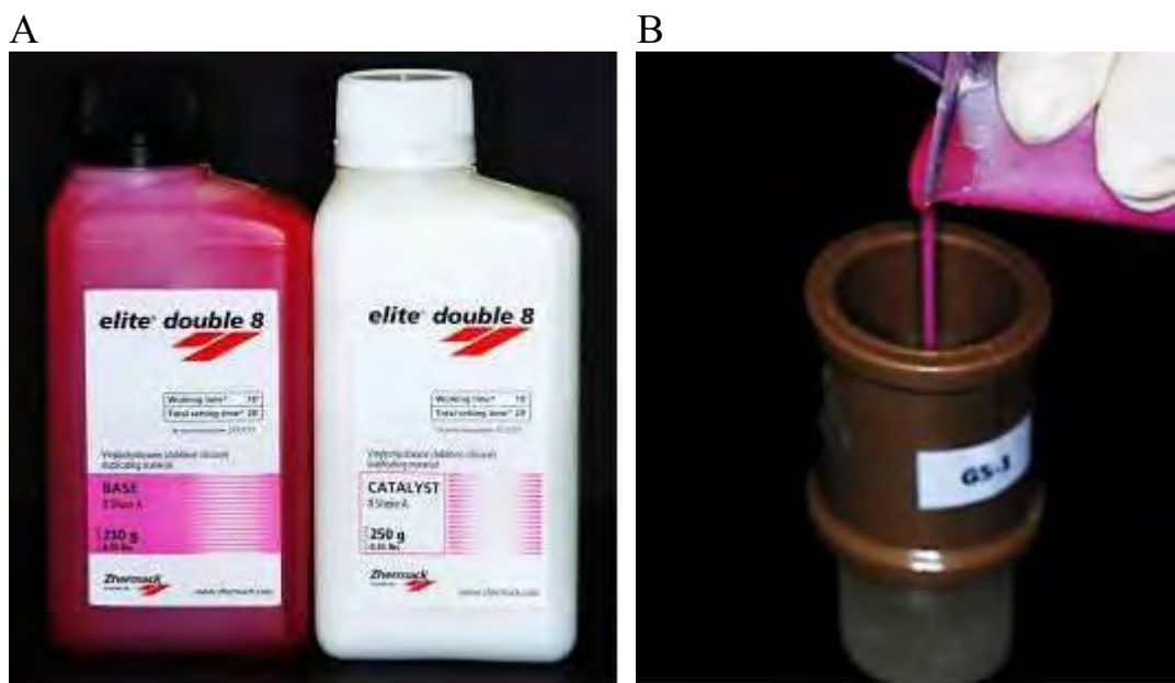
Figura 9 – a) Material de moldagem utilizado no estudo; b) Material de moldagem após manipulação sendo vertido sobre a amostra.
