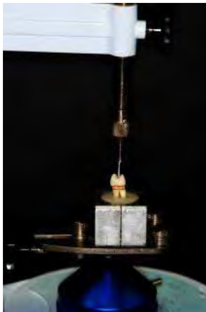
Figura 3 - Dente sendo inserido em resina acrílica com auxílio de uma matriz metálica e delineador.
