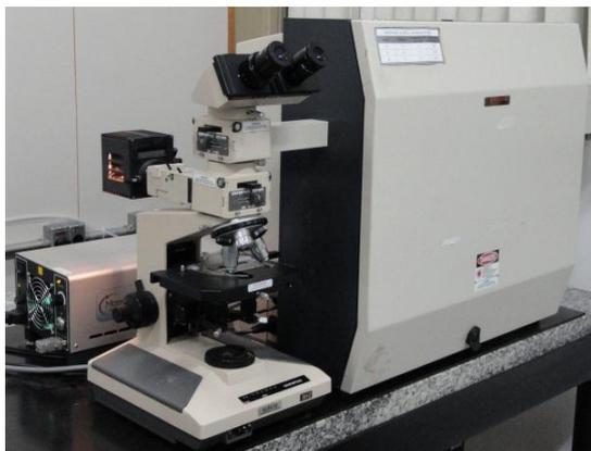
Figura 4 – Sistema utilizado para a análise de espectroscopia de retroespalhamento Raman.
