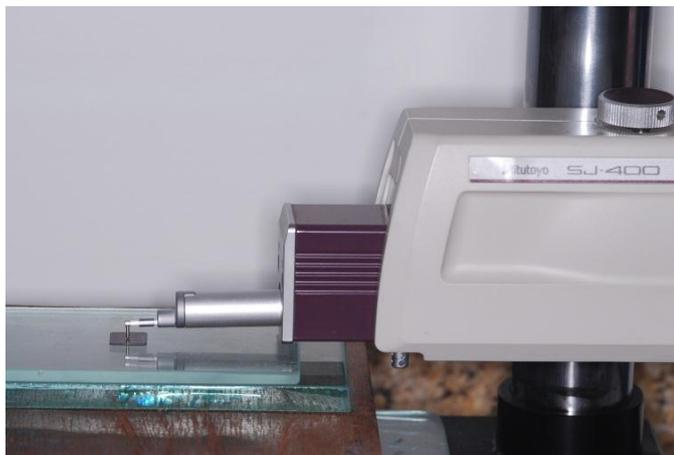
Figura 8 – Amostra em rugosímetro.
