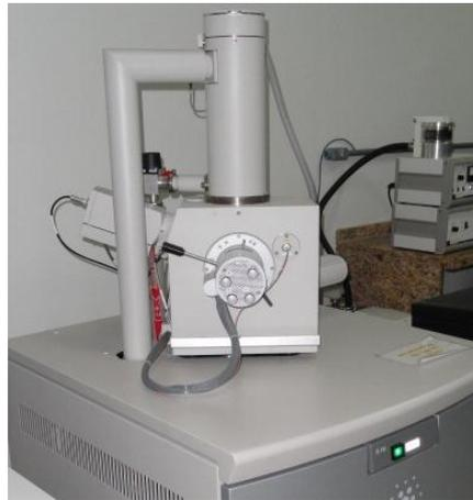
Figura 7 – Microscópio eletrônico de varredura.
