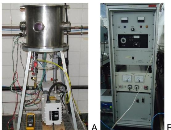
Figura 1 – A) reator para deposição dos filmes de DLC por PECVD; B) fonte de descarga contínua acoplada ao reator.
