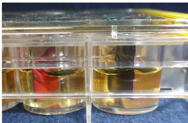
Figura 12 – Lâminas de titânio em meio de cultura. As lâminas ficaram suspensas a 1 mm do fundo dos poços.
