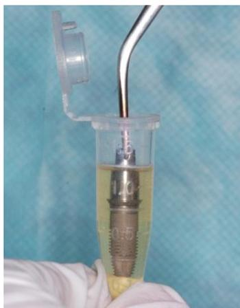
Figura 17 – Implante imerso por 30 s em caldo BHI, imediatamente após inoculação, para verificação de possível contaminação externa imediata.
