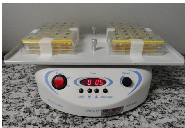
Figura 10 – Placas de 24 poços com meio de cultura em plataforma agitadora.
