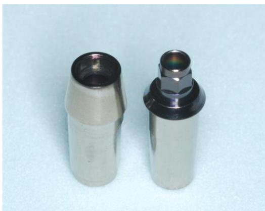
Figura 14 – Pilares após deposição de filmes de DLC (HE à esquerda e HI à direita).
