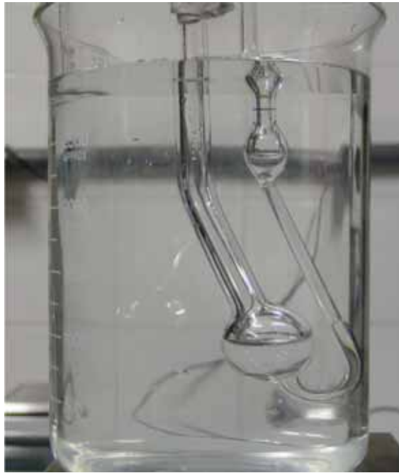
Figura 4.14 – Viscosímetro de Ostwald.
