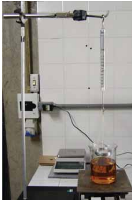
Figura 4.13 – Arranjo experimental para a medição da tensão superficial.
