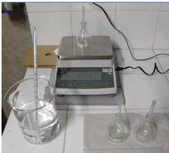
Figura 4.12 – Medição da massa de um volume de líquido com o picnômetro.
