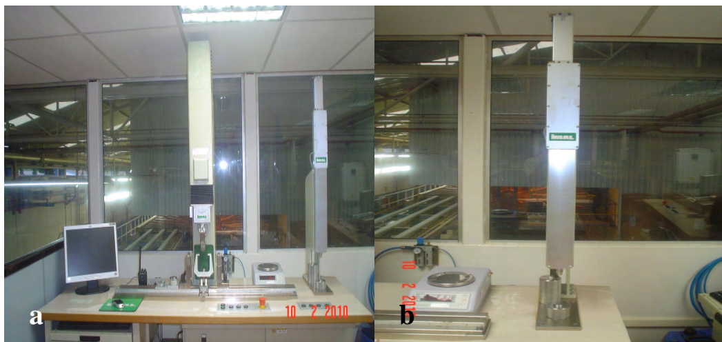
Figura 9 – Máquina universal de ensaios marca IMAL, utilizada na realização de ensaios físico-mecânicos dos corpos-de-prova das faixas 1 e 3. a) vista geral da máquina; b) detalhe do sistema de medição de dimensões dos corpos-de-prova, com uso de transdutor digital.
