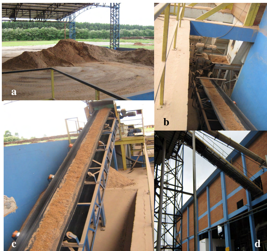
Figura 7 – Adição da serragem às partículas. a) estocagem de serragem; b) até d) transporte da serragem dosada ao silo de partículas úmidas.
