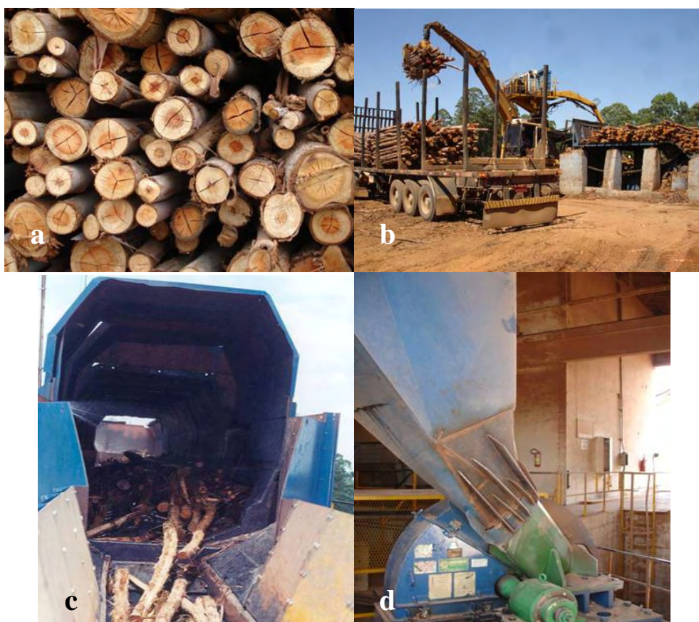
Figura 3 – Produção de cavacos a partir dos toretes. a) toretes de madeira utilizadas no processo; b) transporte dos toretes para o descascador; c) visão interna do descascador; d) picador de discos.
