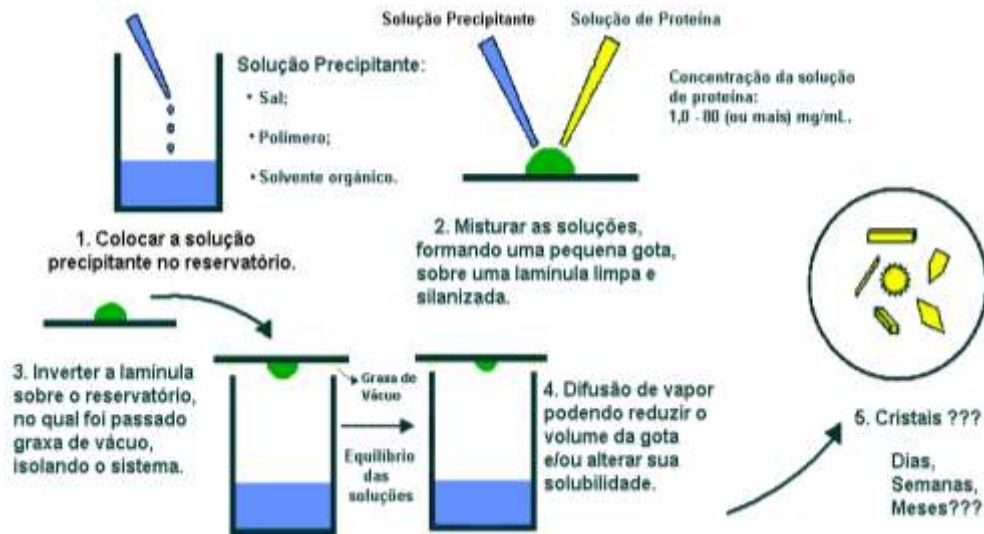
Figura 5: Diagrama das etapas de montagem do método de cristalização por difusão de vapor, sistema hanging drop .
