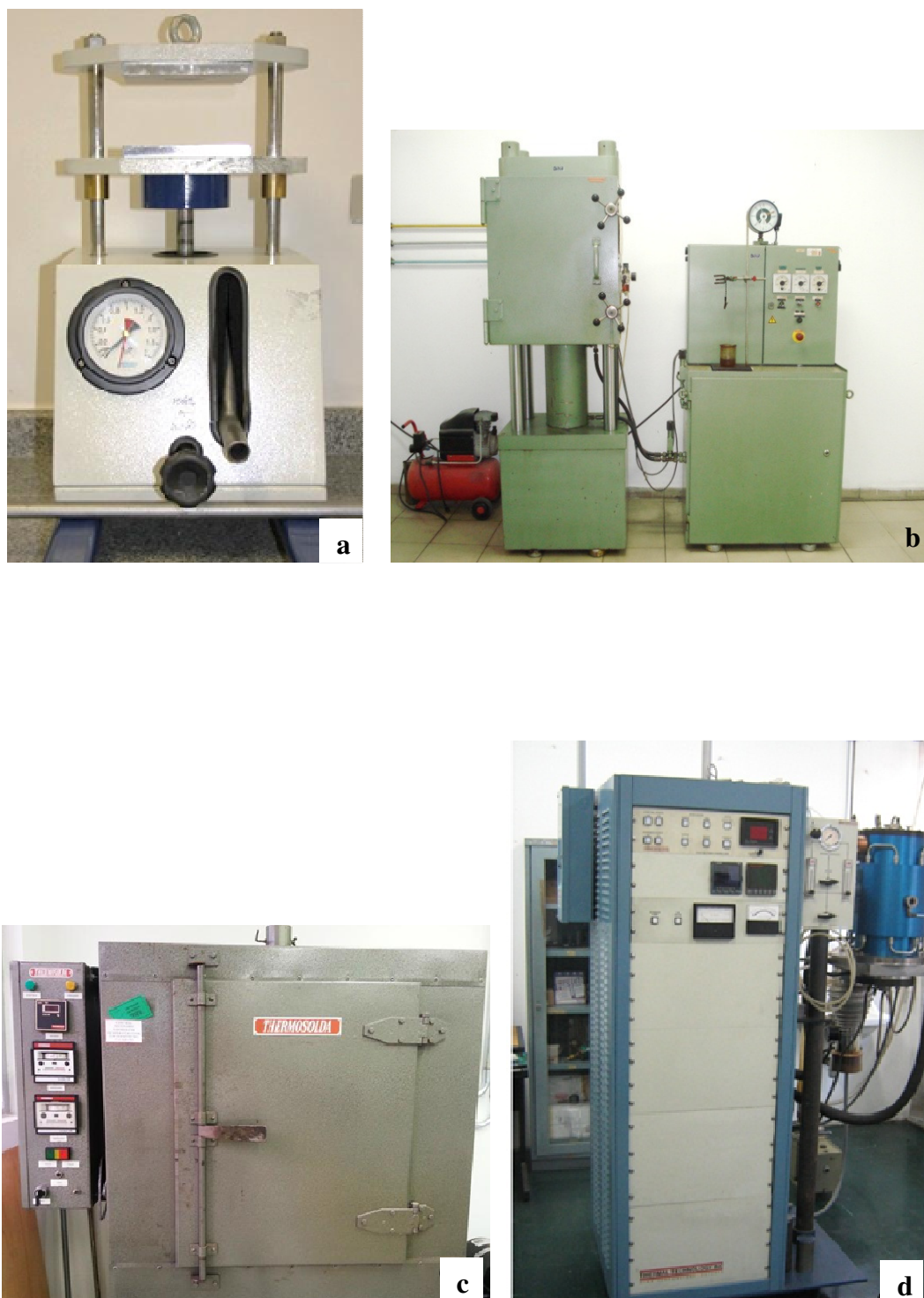
Figura 2 - Equipamentos utilizados na confecção das amostras: a) prensa hidráulica uniaxial; b) prensa isostática; c) forno à vácuo para remoção da ureia; d) forno a vácuo para sinterização.
