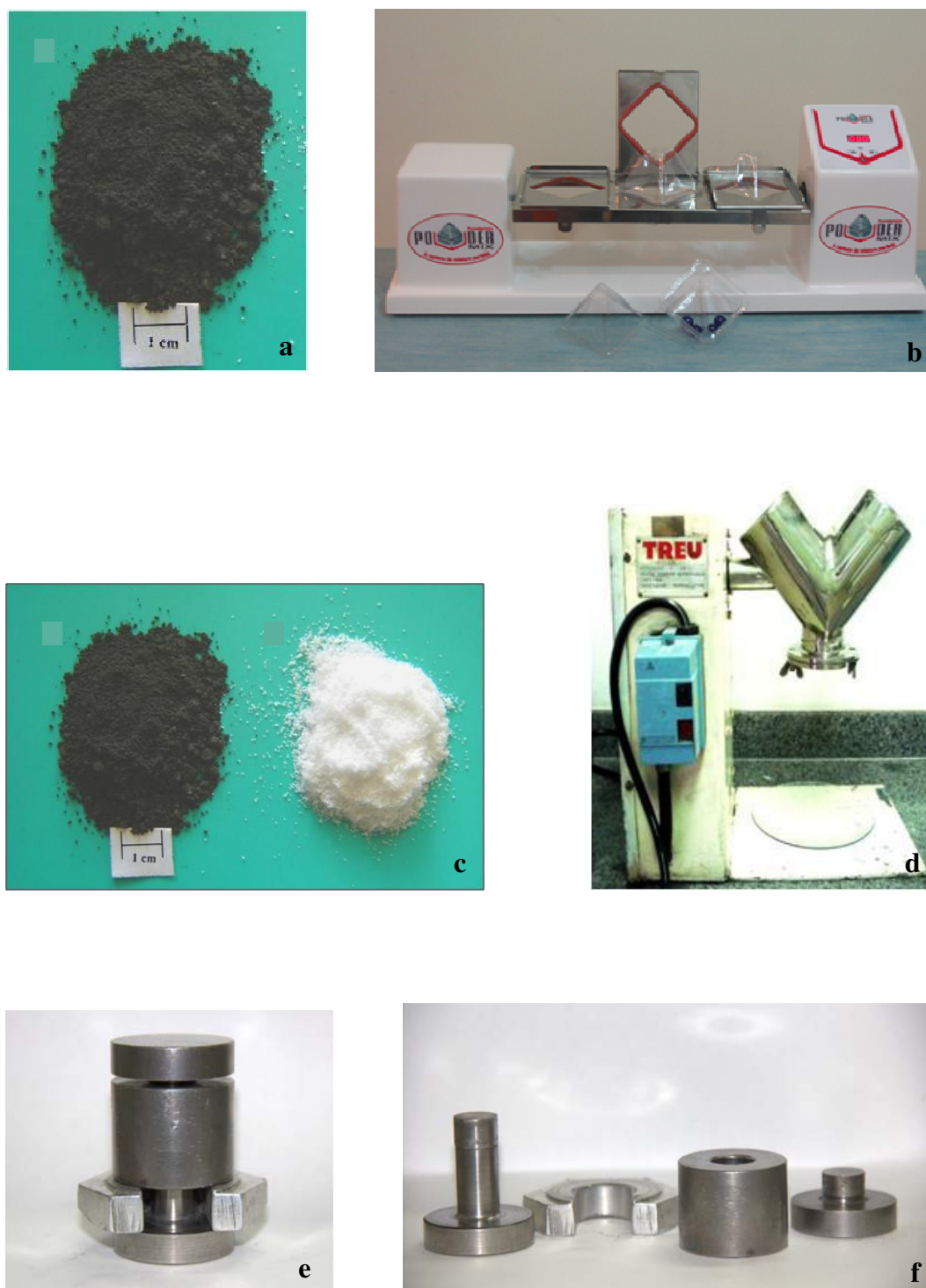
Figura 1 - Confeção das amostras: a) pó do Ti; b) misturador em Y (modelo Powdermix); c) Pós da liga pronta e uréia em grânulos; d) misturador em Y (modelo Treu); e) matriz montada; f) componentes da matriz.
