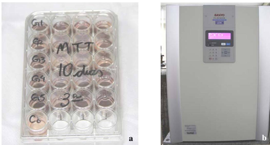
Figura 10 - Isolamento celular: a) Placa de cultura contendo as amostras, meio de cultura e células osteogênicas; b) Estufa de CO 2 na qual as placas são acondicionadas.
