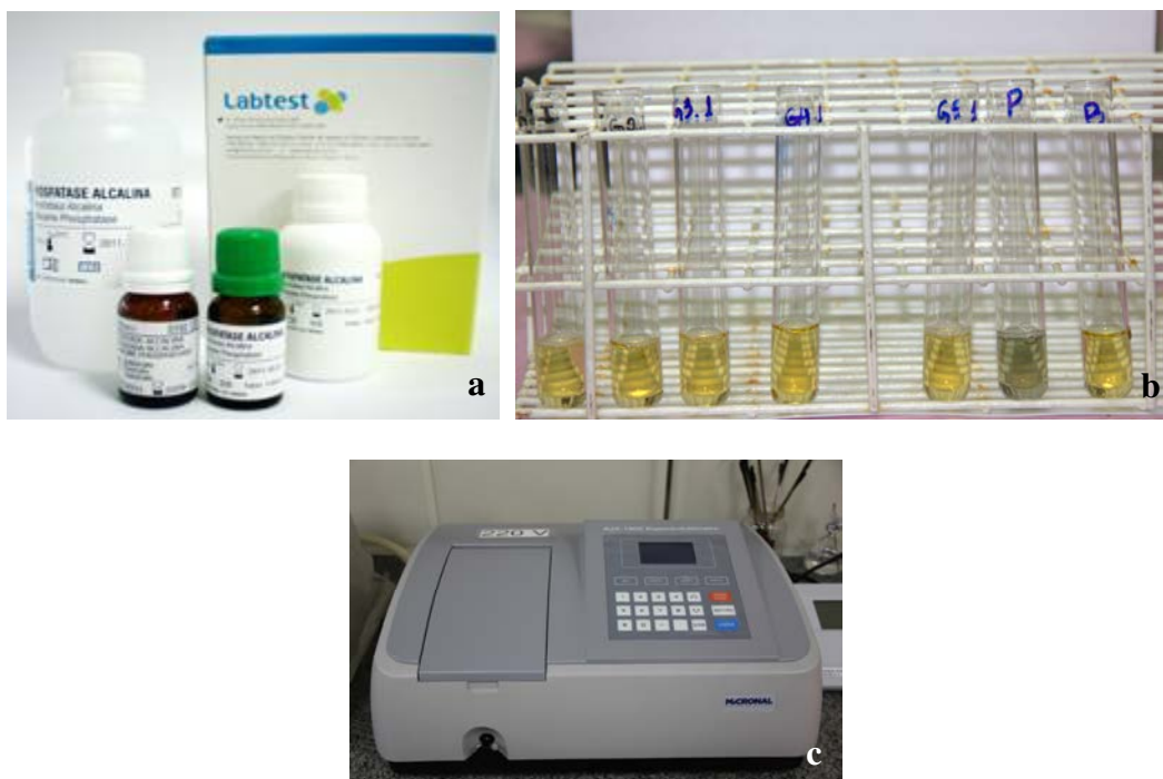
Figura 14 - Avaliação da atividade da fosfatase alcalina: a) Kit comercial Labtest; b) tubos de ensaio contendo os reagentes e as alíquotas das amostras; c) espectrofotômetro.
