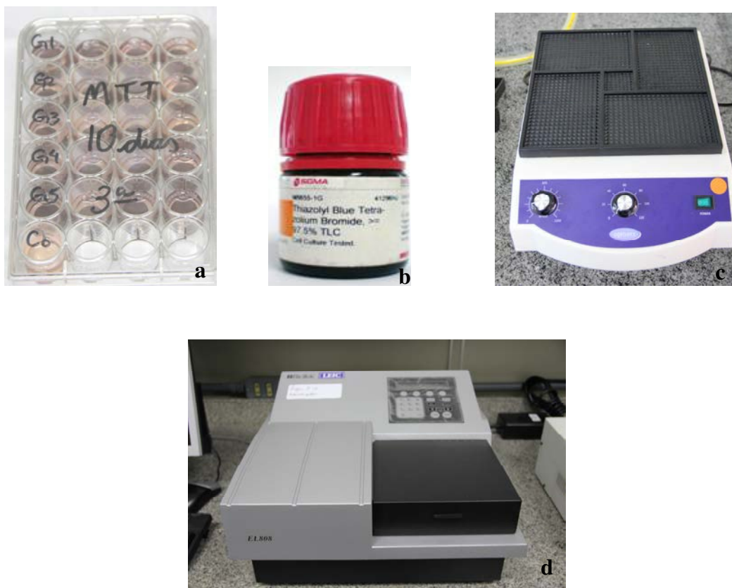
Figura 12 - Viabilidade Celular . a) Placa para o teste de viabilidade celular; b) sal MTT; c) mesa agitadora orbital; d) leitor de microplaca.
