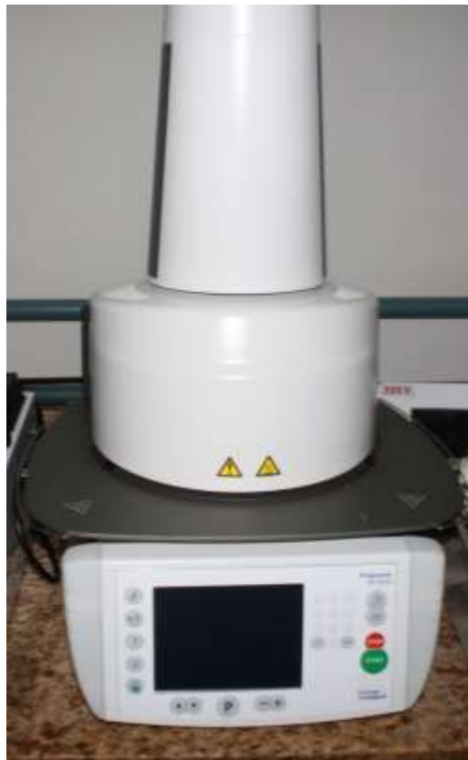
Figura 4 – Forno Programat EP 5000 usado para injeção das cerâmicas.
