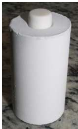
Figura 5: Revestimento contendo as cerâmicas injetadas após saírem do forno de injeção.
