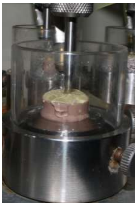
Figura 10 - Máquina de ciclagem termo-mecânica ER 37000 (Erios, Brasil). Posicionamento do espécime na máquina.
