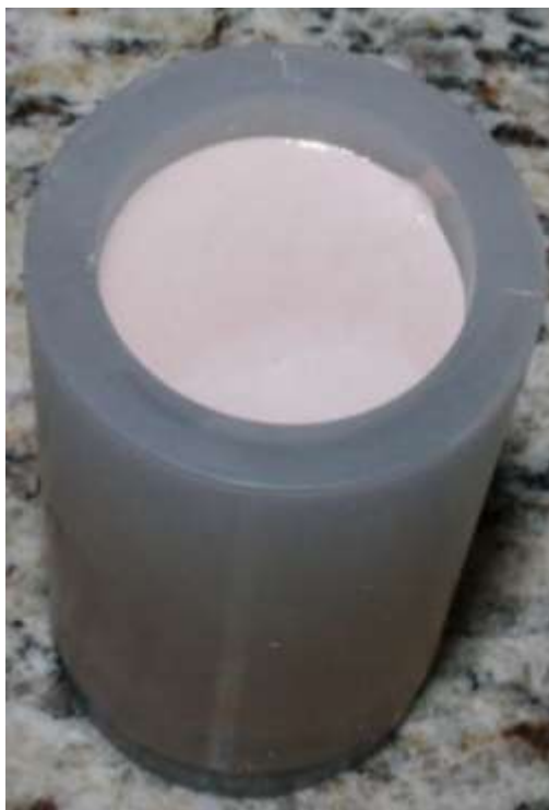
Figura 3 - Revestimento vertido sobre os espécimes e protegido do escoamento pelo anel de silicone.
