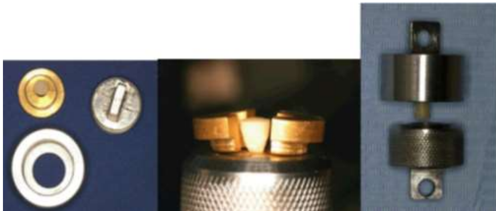
Figura 11 - Adaptação dos espécimes cerâmicos no modelo metálico para ensaio mecânico.
