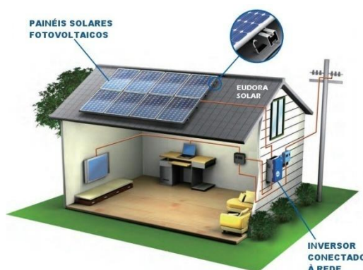
Figura 7. Sistema de microgeração residencial conectado à rede Fonte: (EUDORA SOLAR, 2013)
