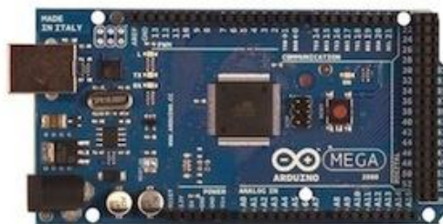
Figura 20. Plataforma de prototipagem Arduino – modelo MEGA 2560 Fonte: (ARDUINO PROJECT, 2014)
