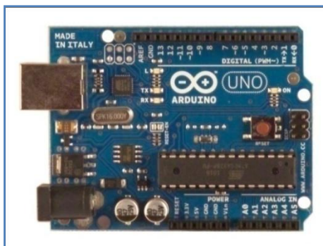
Figura 10. Plataforma de prototipagem Arduino – modelo UNO Fonte: (ARDUINO PROJECT, 2014)
