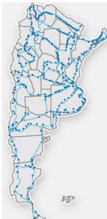
Figura 16 - Rede de fibra ótica do Plano Argentina Conectada. Fonte: http://www.argentinaconectada.gov.ar/contenidos/red_federal_de_fibra_optica.html
