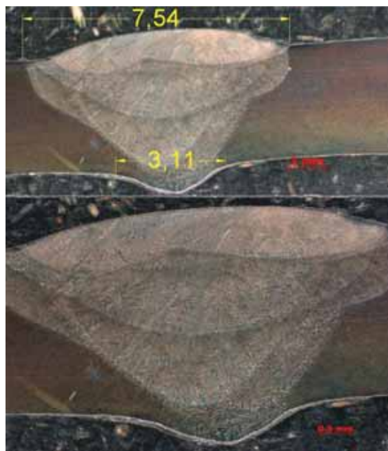
Figura 35- Amostra sem tratamento térmico com três reparos.
