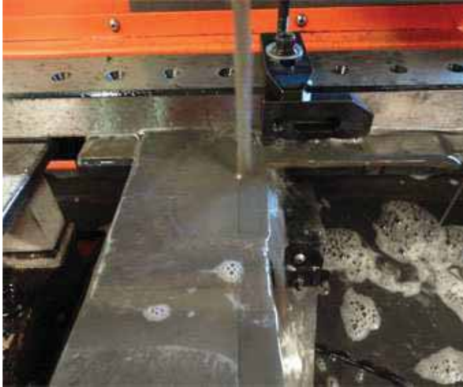
Figura 28- Confeção dos corpos de prova utilizando eletroerosão a fio.
