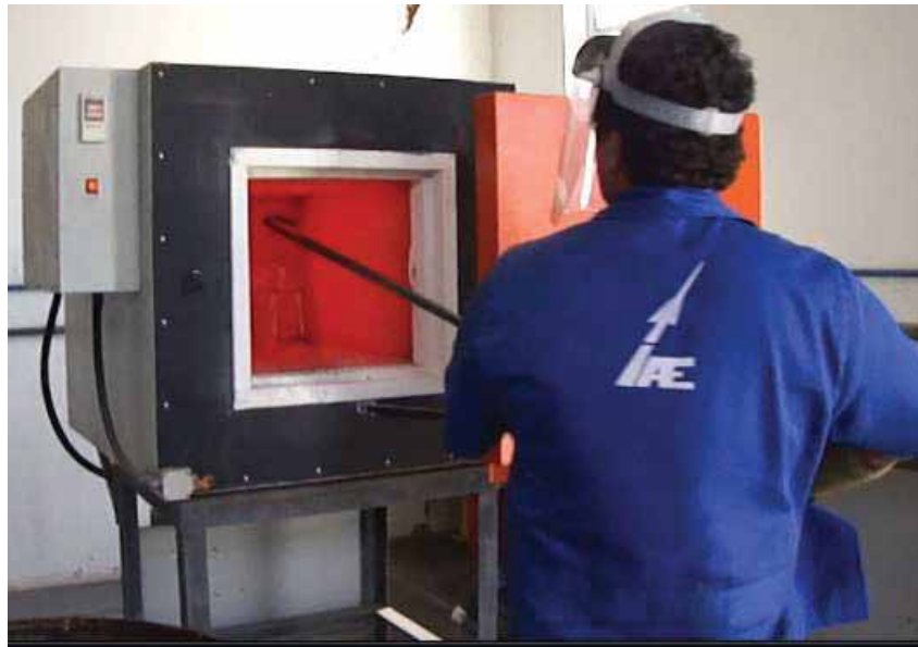
Figura 30- Retirada dos CDPs do forno de solubilização.
