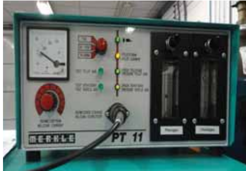
Figura 19- Módulo de plasma da marca MERKLE BALMER modelo PT 11.
