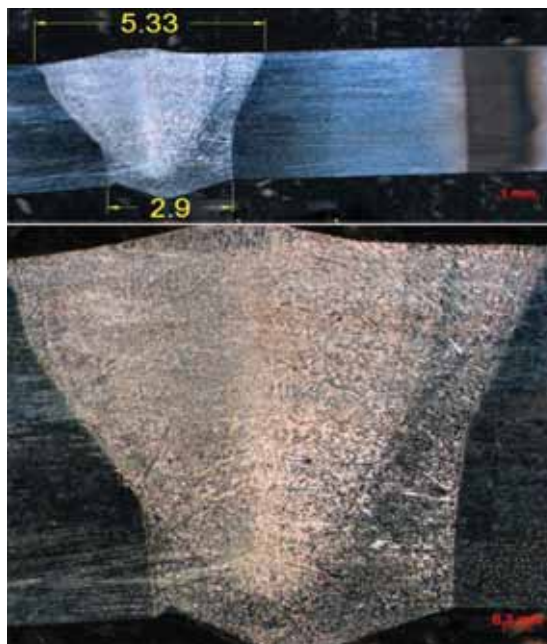
Figura 36- Amostra com tratamento térmico e sem reparo.
