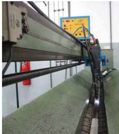
Figura 21- Dispositivo de soldagem longitudinal fabricado no IAE.
