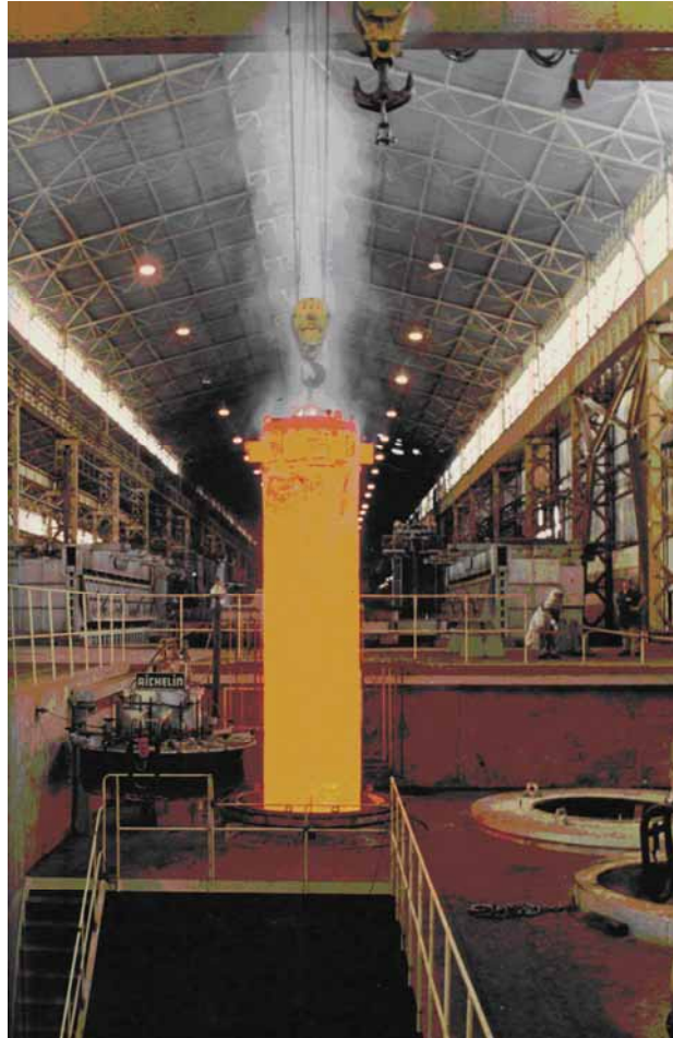
Figura 2- Tratamento térmico envelope motor de foguete.
