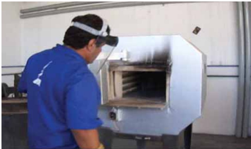
Figura 31- Posicionamento dos corpos de prova no forno de envelhecimento.
