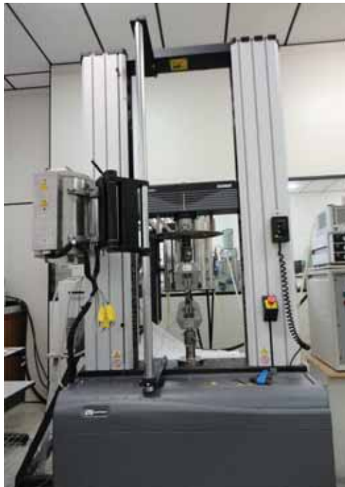
Figura 17- Máquina utilizada para a realização dos ensaios de tração.
