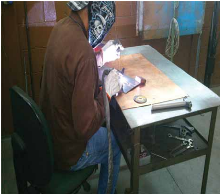
Figura 23- Realização do reparo pelo processo TIG, de forma manual.
