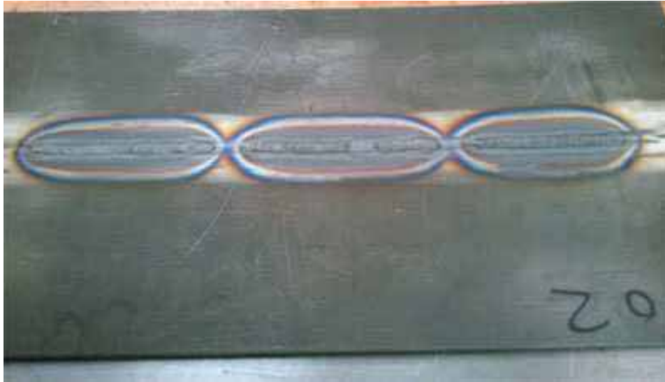
Figura 24- Imagem de junta soldada após a realização do reparo.
