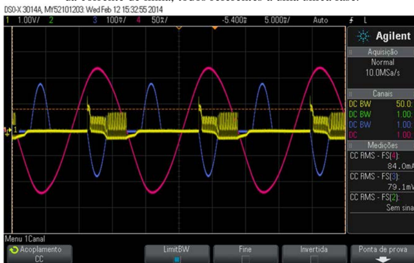
Figura 53- Corrente de linha, corrente no reator do D-TCSC e pulso de disparo no semi-ciclo positivo da corrente de linha, todos referentes a uma única fase.
