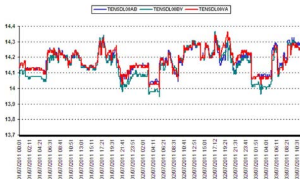
Figura 9- Perfil de tensão na subestação de energia em quilovolts (kV).
