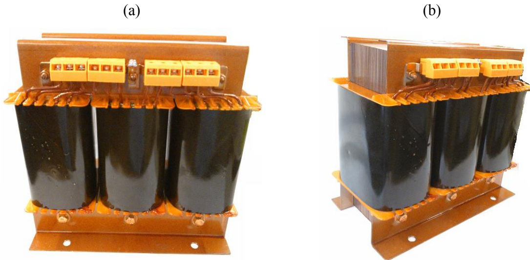
Figura 36 – Protótipo do filtro eletromagnético construído: (a) Visão frontal; (b) Visão lateral.
