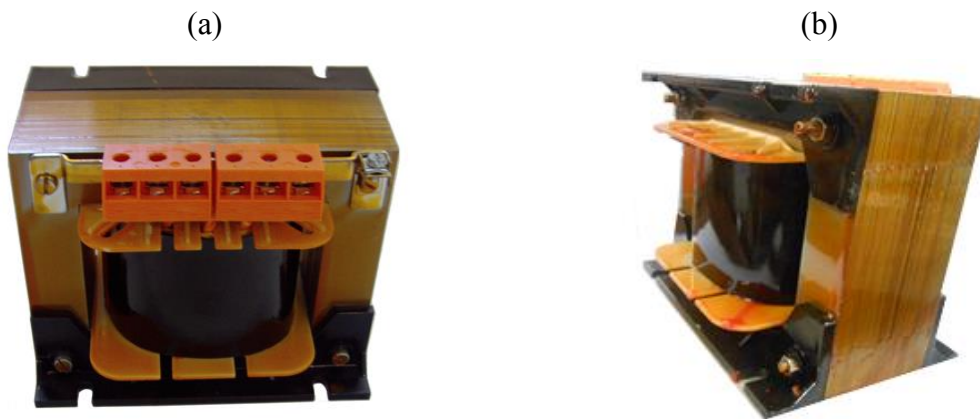
Figura 38 – Protótipo do bloqueador construído: (a) Visão frontal; (b) Visão lateral.
