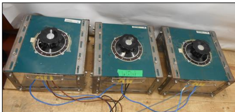
Figura 79 – Três variadores de tensão CA ( variacs ) utilizados nos ensaios.
