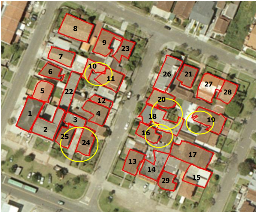
Figura 29 – Contornos de telhado extraídos no espaço-objeto no experimento 1.
