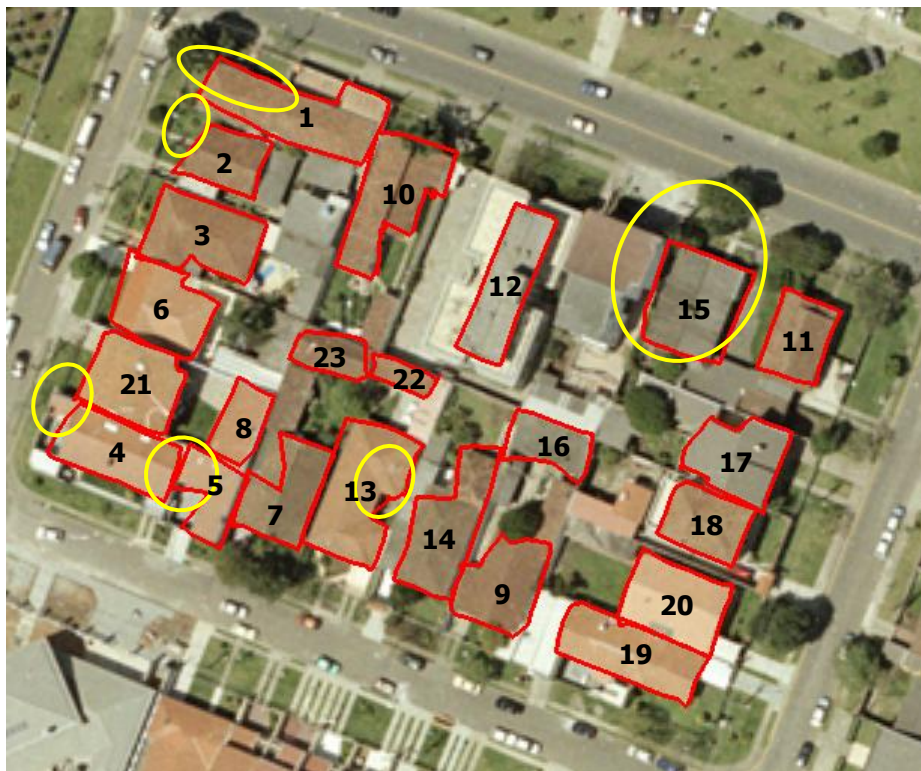
Figura 39 – Contornos de telhado de edifícios extraídos no experimento 4.
