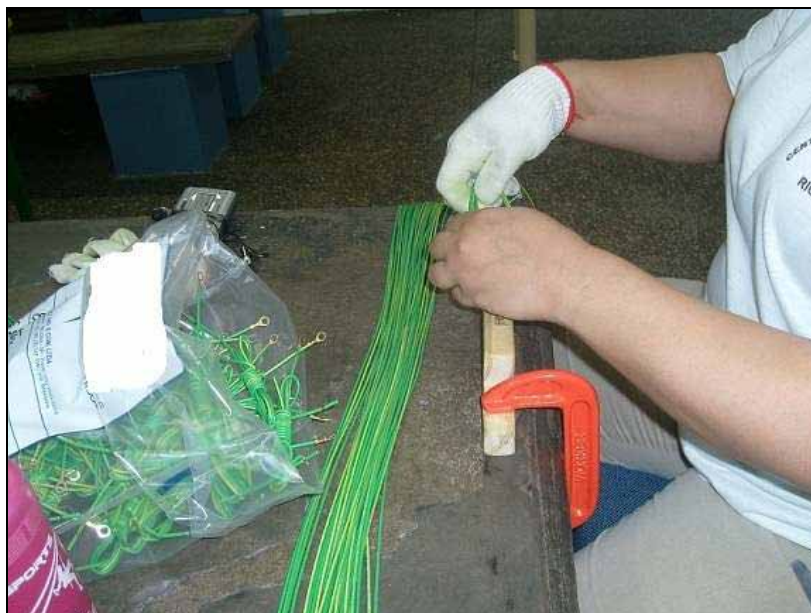
Foto 18. Fio terra sendo finalizado na oficina da E2. Do lado esquerdo, embalagem com o produto pronto. Por Camilla Marcondes Massaro.
