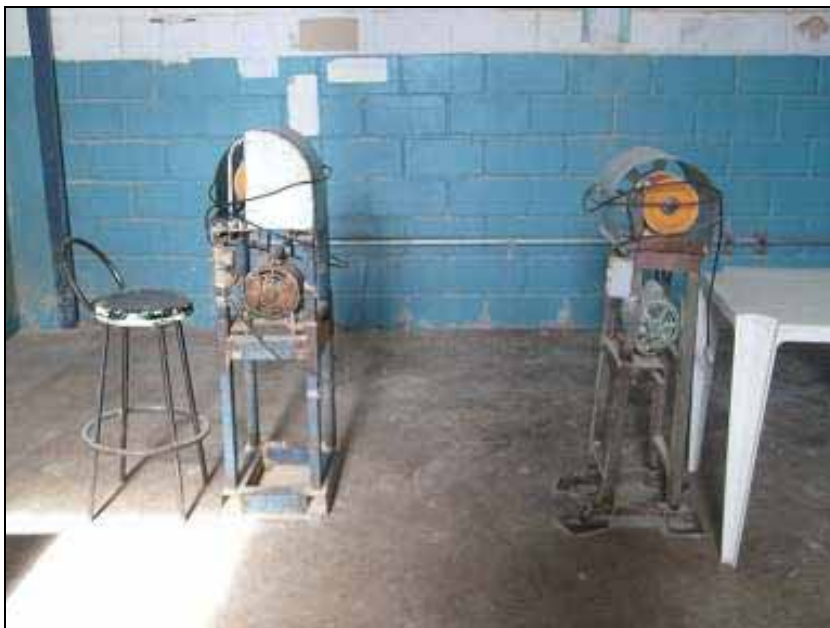
Foto 31. Máquina de fazer ponta nos palitos da E8. Por Camilla Marcondes Massaro.
