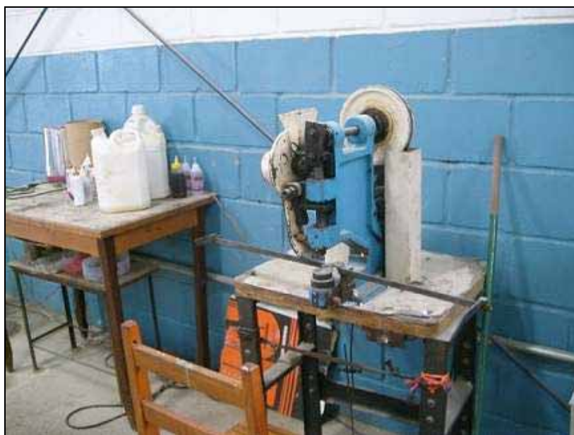
Foto 24. Oficina da E6. Máquina para colocar o ilhós, ao lado galões de cola branca. Por Camilla Marcondes Massaro.
