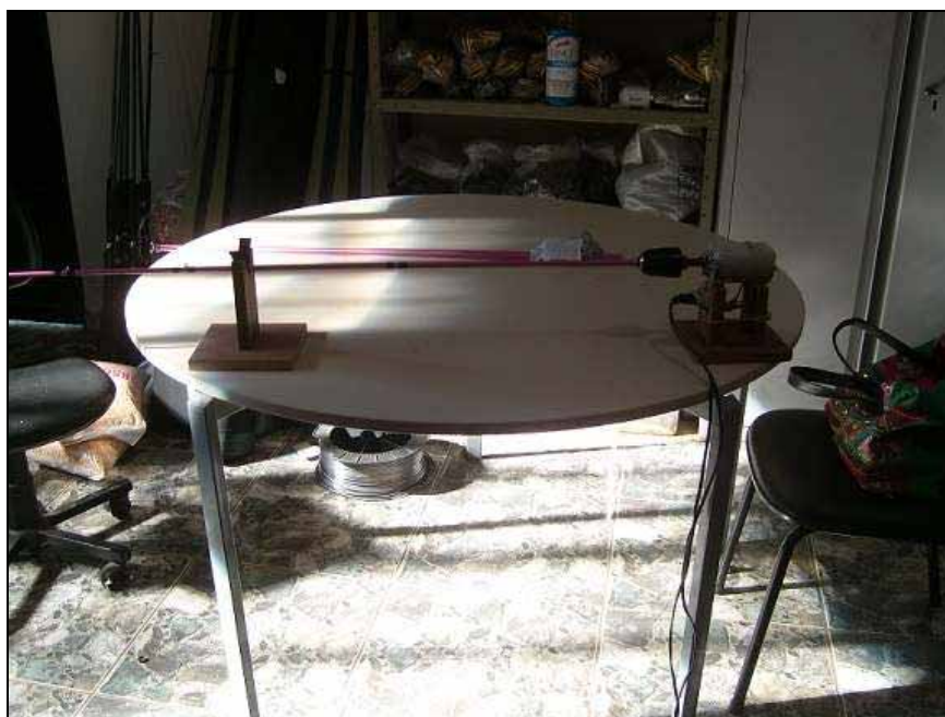
Foto 34. Equipamento que segura e roda a vara de pesca para a colocação dos pontos. Montado pelos entrevistados da E10 no dia da entrevista. Por Camilla Marcondes Massaro.
