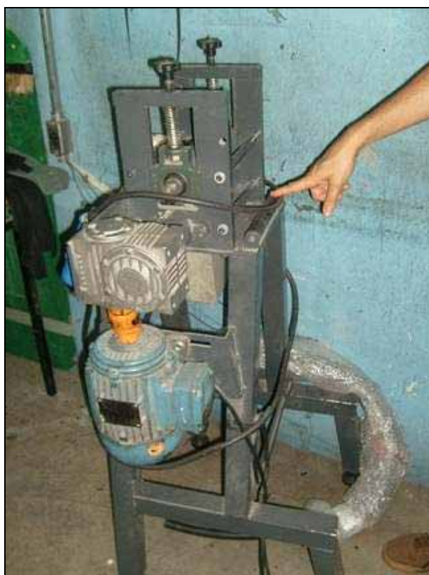
Foto 12. Máquina para corte de peças de borracha da E5. Corte e finalização de peças em borracha. Por Camilla Marcondes Massaro.
