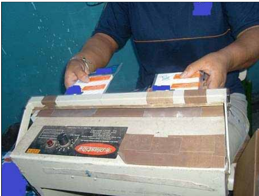
Foto 09. Máquina seladora da E1. Embalagem de grelhas (ralos). Por Camilla Marcondes Massaro.
